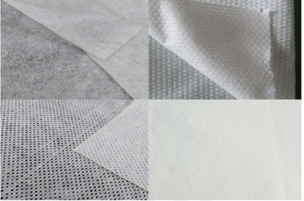
Şekil 3.4. Spunlace kumaş desenleri; düz desen, petek desen, mesh desen ve kağıtlı ürün
