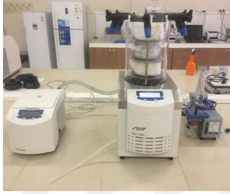
Şekil 2.2. Soğuk metotta liyofilizasyon işlemi
