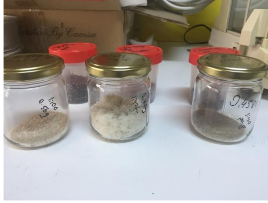
Şekil 3.3. Solda, 1:100 oranında sulandırılıp 50°C 'de bir gece kurutma sonunda elenen musilaj; Ortada, 1:40 oranında sulandırıldıktan sonra 5 gün dondurarak kurutulan chiadan elenen musilaj; Sağda, 1:40 oranında sulandırılıp pH=8'e ayarlanan ve 50°C 1 gece kurutularak elenen musilaj görüntüsü
