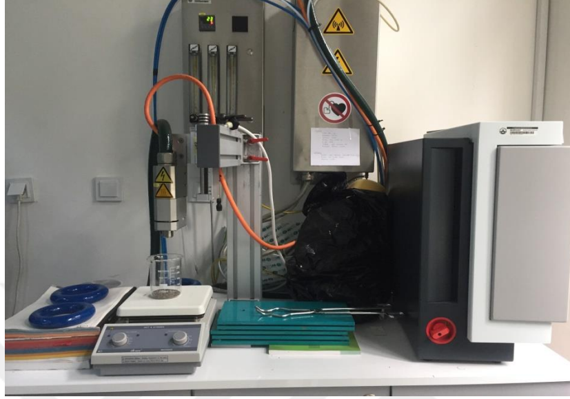
Şekil 2.1. Atmosferik plazma jetin uygulanması
