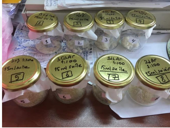
Şekil 2.7. 1,2,3,4 nolu kavanozlar soğuk metotla elde edilen musilajlar; 5,6,7,8 nolu kavanozlar sıcak metotla elde edilen musilajlar
