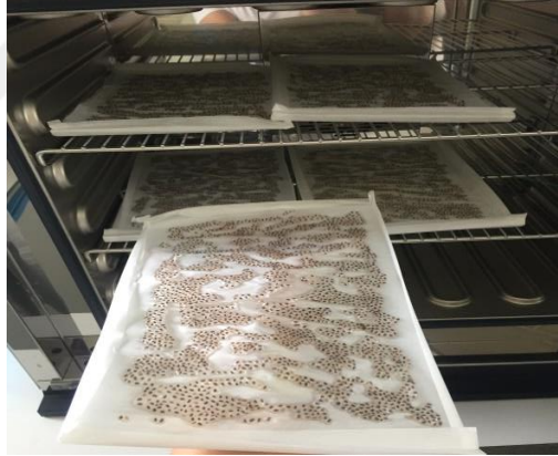
Şekil 2.3. Sıcak metotla etüvde kurutulan örnekler
