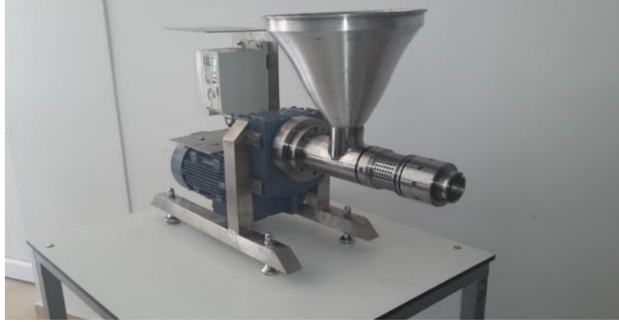
Şekil 1.1. Soğuk pres ekstraktörü (Koç, 2016)
