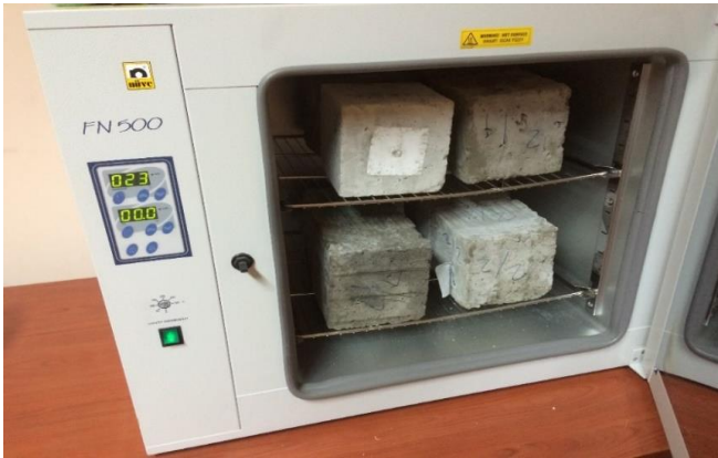
Şekil 3.5. Numunelerin su emme deneyindeki etüv görüntüsü
