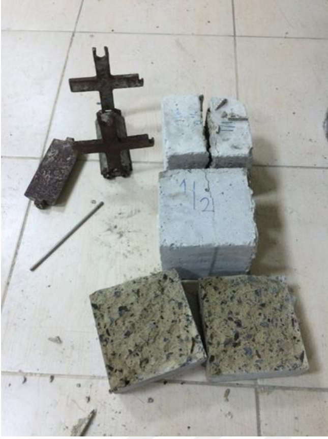
Şekil 3.7. Yarmada çekme deneyi
