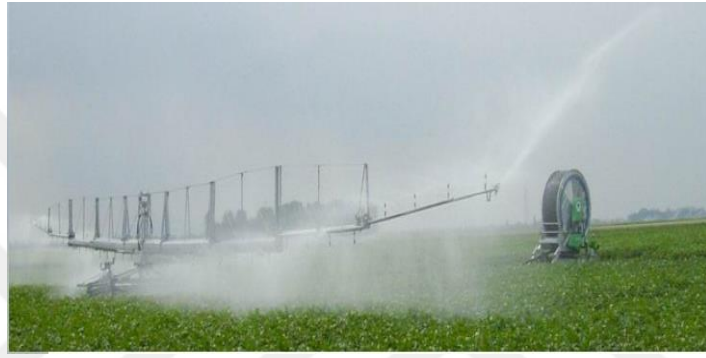
Şekil 1.4. Kanatlı tip sulama ekipmanı (Four wheel chassis boom)
