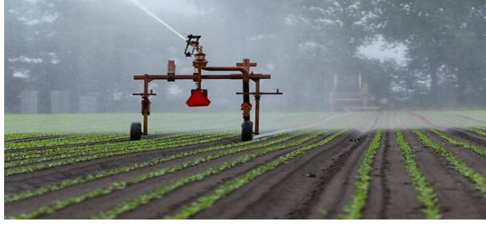
Şekil 1.3. Tabancalı tip sulama ekipmanı (Hose reel traveler irrigation)
