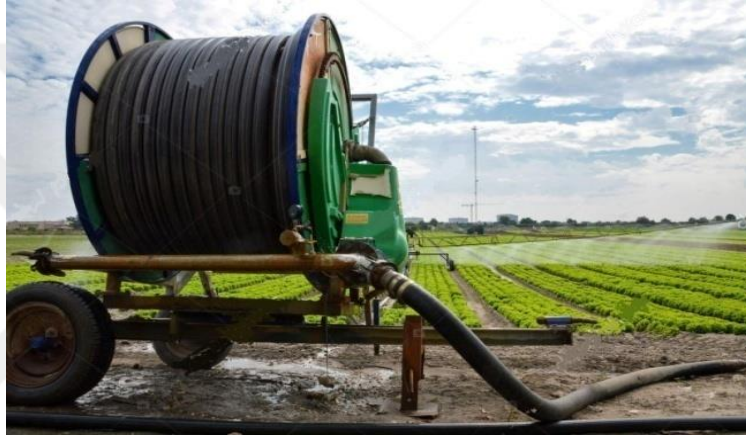
Şekil 1.7. Tamburlu Sulama sulama (yağmurlama sulama sistemleri)
