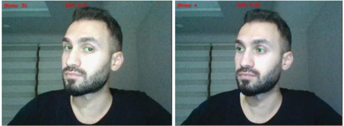
Şekil 2.23. Kafanın sağ tarafa 45 derecelik açı ile durumundayken gözlerin hem kameraya bakarken hem de bakılmadığı durumdaki kırplımlarının hesaplanması.
