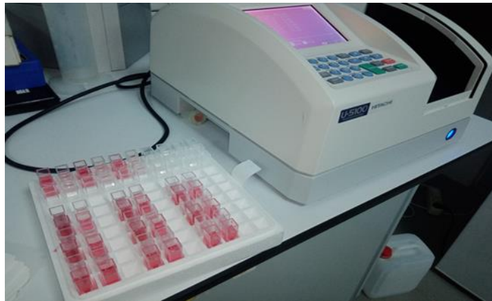
Şekil 2.14 Spektrofotometre ile TPI ölçümleri (Orijinal fotoğraf Semih Erişken, 2021)
