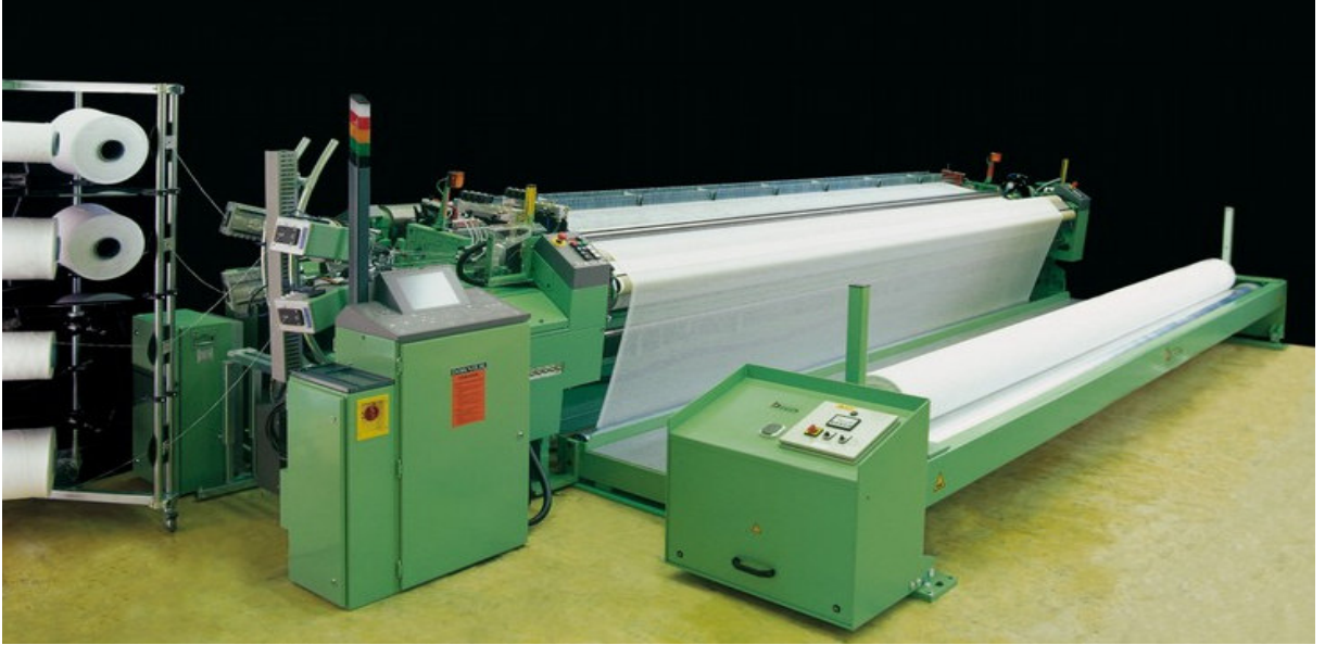
Şekil 2.10. Dornier Easlyno dokuma makinesi ( Anonim 2016c)
