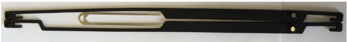
řekil 3.4. Numuneler dokunurken kullanılan leno gücü
