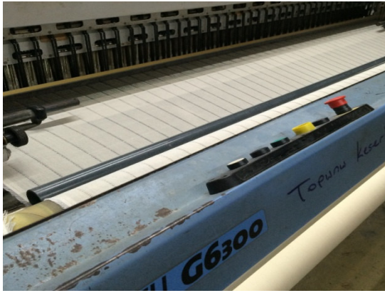
řekil 3.1. Dokuma tezgahında dokunan numuneler
