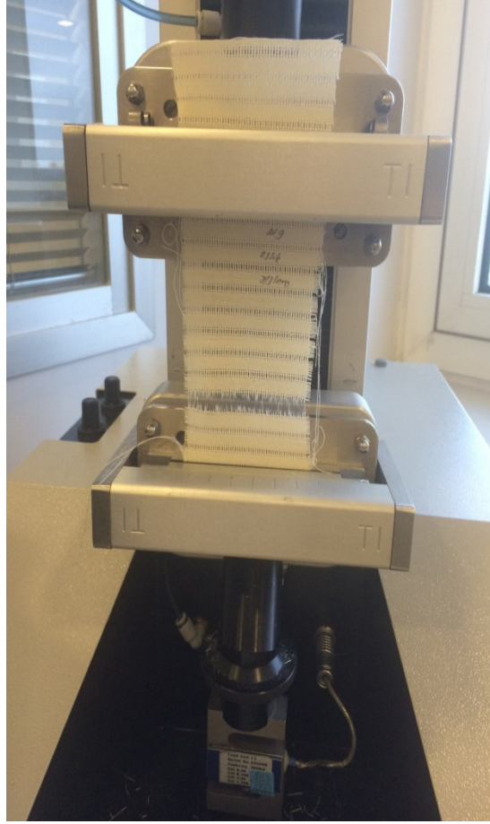
Şekil 3.14. Kopma mukavemeti cihazında kumaşın konumu
