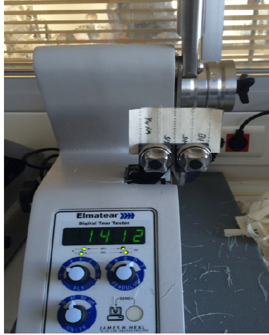
Şekil3.11. Yırtılma mukavemeti cihazında kumaşın konumu
