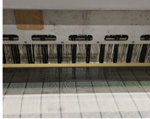
řekil 3.2. Numuneler dokunurken döner gücüler
