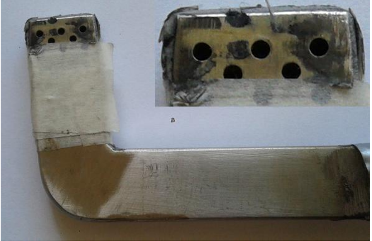
Şekil - 5. 28 Boru Dizaynının Değiştirilmesi ve Geniş Alan Üzerinde Küçük Deliklerin Varlığı Resmi
