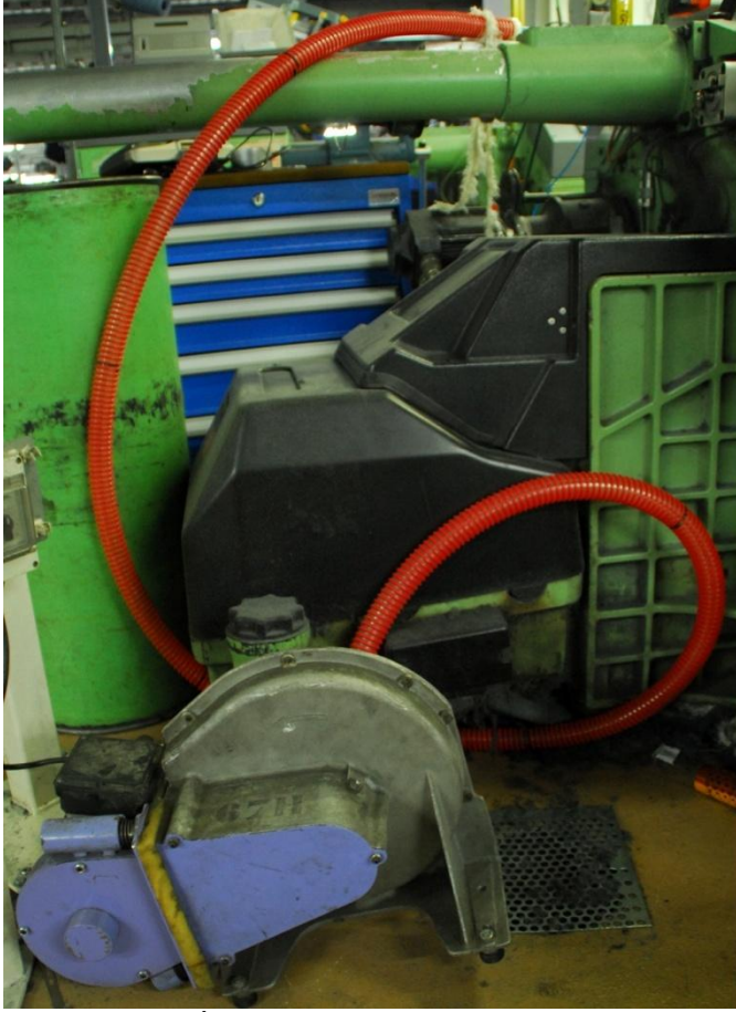
Şekil - 5. 37 İplik Emiş Aparatı Vakum Pompası ve bağlantı düzeni
