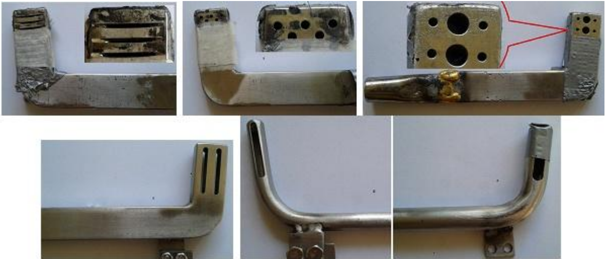
Şekil - 5. 34 İplik Emiş Düzeleri ( üst sıra: A_1, A_2, A_3 ve alt sıra: A_4, B_1 ve B_2 olarak adlandırılmıştır.)
