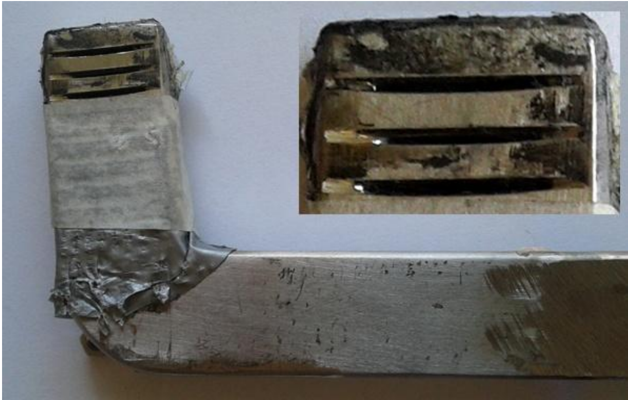
Şekil - 5. 26 Boru Kesitine Dik Olarak Birden Fazla Çektik Oluşturulması Resmi
