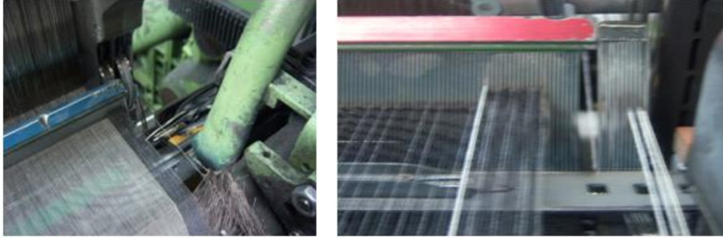
Şekil - 5. 17 Hava Emişi Sisteminin Mevcut Sistem İle Karşılaştır
