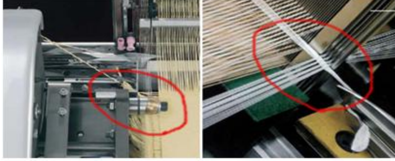
Şekil - 2. 8 Dokuma Tezgâhında Atkı Telefinin Oluşumu
