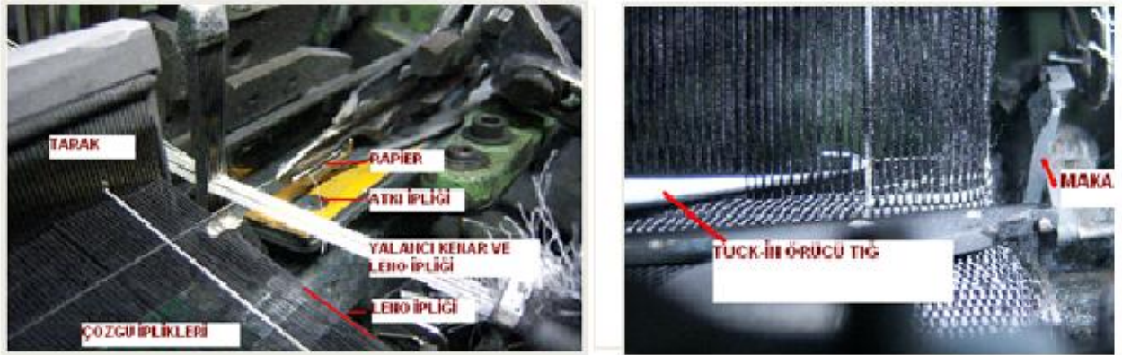
Şekil - 3. 8 Kenar Saçağı ve Oluşum Mekanizması
