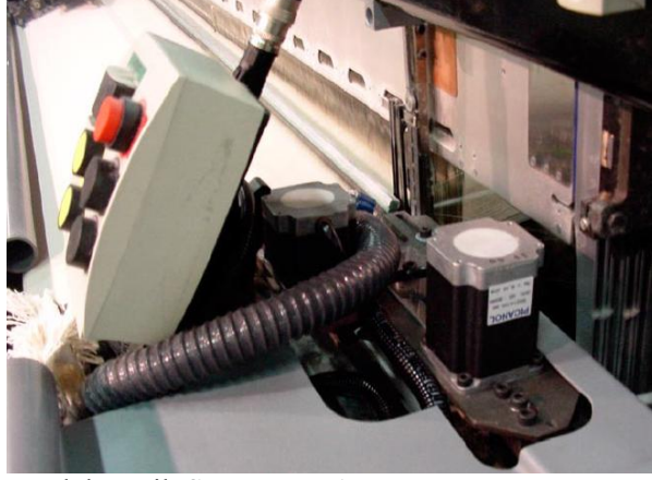
Şekil - 2. 15 ERGO II Elektronik Sağ Kanca Açıcı
