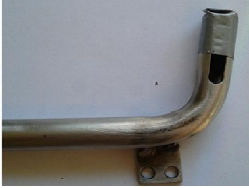
Şekil - 5. 24 Düze B_1 Hava Emiş Aparatına Göre Daha Geniş Çentikli Aparat Resmi
