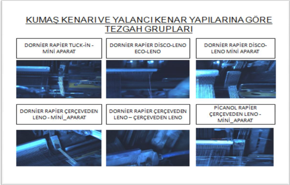
Şekil - 3. 1 Dokuma İşletmesinde, Rapier Tezgâhların Kumaş Kenarı ve Yalancı Kenar Yapılarına Göre Sınıflandırılması
