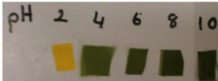
Şekil 7.4 % 0,7 Bromokresol Moru %3 Tannik asit ile boyanmış naylonun farklı pH çözeltilerinde 1 saat sonra sahip olduğu renk
