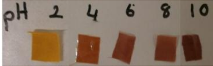
Şekil 7.19 % 1,5 Alizarin Kırmızı S %3 Hyrocol APR ile boyanmış naylonun farklı pH çözeltilerinde 1 saat sonra sahip olduğu renk
