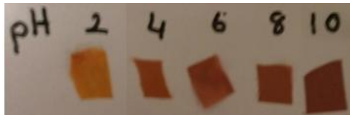
Şekil 7.16 %1 Alizarin Kırmızı S %3 Setafix S ile boyanmış naylonun farklı pH çözeltilerinde 1 saat sonra sahip olduğu renk
