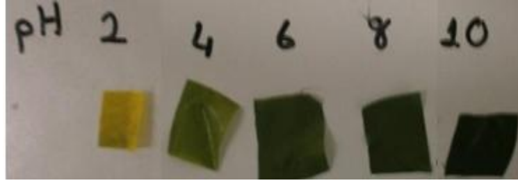
Şekil 7.6 % 1 Bromokresol Moru %3 Setafix S ile boyanmış naylonun farklı pH çözeltilerinde 1 saat sonra sahip olduğu renk
