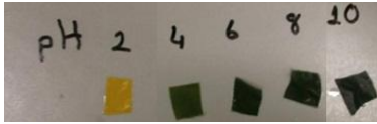
Şekil 7.2 % 0,7 Bromokresol Moru %3 Setafix S ile boyanmış naylonun farklı pH çözeltilerinde 1 saat sonra sahip olduğu renk
