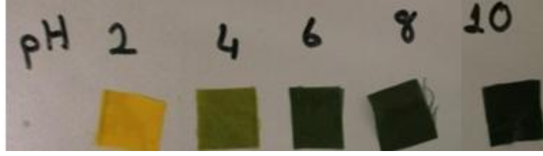
Şekil 7.5 % 1 Bromokresol Moru ile boyanmış naylonun farklı pH çözeltilerinde 1 saat sonra sahip olduğu renk
