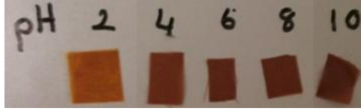
Şekil 7.17 % 1 Alizarin Kırmızı S %3 Tannik asit ile boyanmış naylonun farklı pH çözeltilerinde 1 saat sonra sahip olduğu renk
