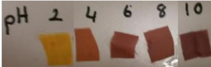
Şekil 7.15 % 1 Alizarin Kırmızı S ile boyanmış naylonun farklı pH çözeltilerinde 1 saat sonra sahip olduğu renk
