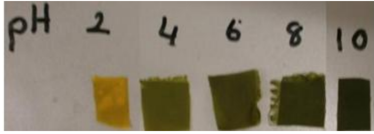
Şekil 7.10 % 1,5 Bromokresol Moru %3 Tannik asit ile boyanmış naylonun farklı pH çözeltilerinde 1 saat sonra sahip olduğu renk
