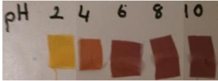
Şekil 7.11 % 0,7 Alizarin Kırmızı S ile boyanmış naylonun farklı pH çözeltilerinde 1 saat sonra sahip olduğu renk
