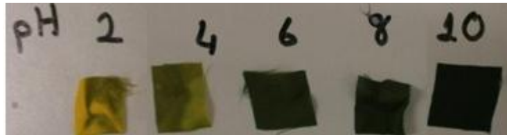
Şekil 7.8 % 1,5 Bromokresol Moru ile boyanmış naylonun farklı pH çözeltilerinde 1 saat sonra sahip olduğu renk
