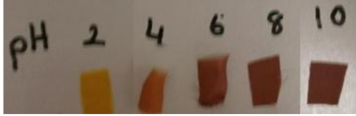
Şekil 7.18 % 1,5 Alizarin Kırmızı S ile boyanmış naylonun farklı pH çözeltilerinde 1 saat sonra sahip olduğu renk
