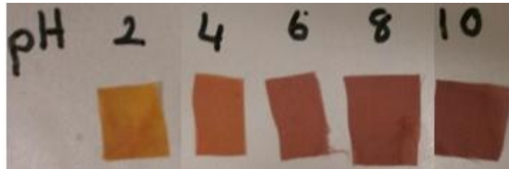
Şekil 7.12 % 0,7 Alizarin Kırmızı S %3 Setafix S ile boyanmış naylonun farklı pH çözeltilerinde 1 saat sonra sahip olduğu renk
