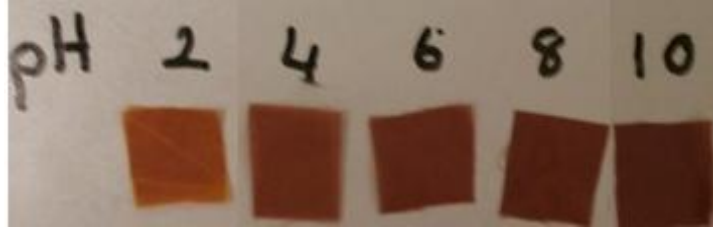
Şekil 7.14 % 0,7 Alizarin Kırmızı S %3 Tannik asit ile boyanmış naylonun farklı pH çözeltilerinde 1 saat sonra sahip olduğu renk
