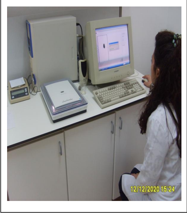
Şekil 3.7. Ispanak yapraklarının tarayıcıdan geçirilip yaprak alanı programına aktarılması
