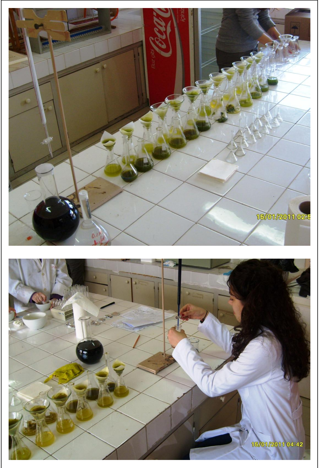
Şekil 3.14. Ispanak yapraklarında askorbik asit tayini amacıyla titrasyon işleminden görüntüler
