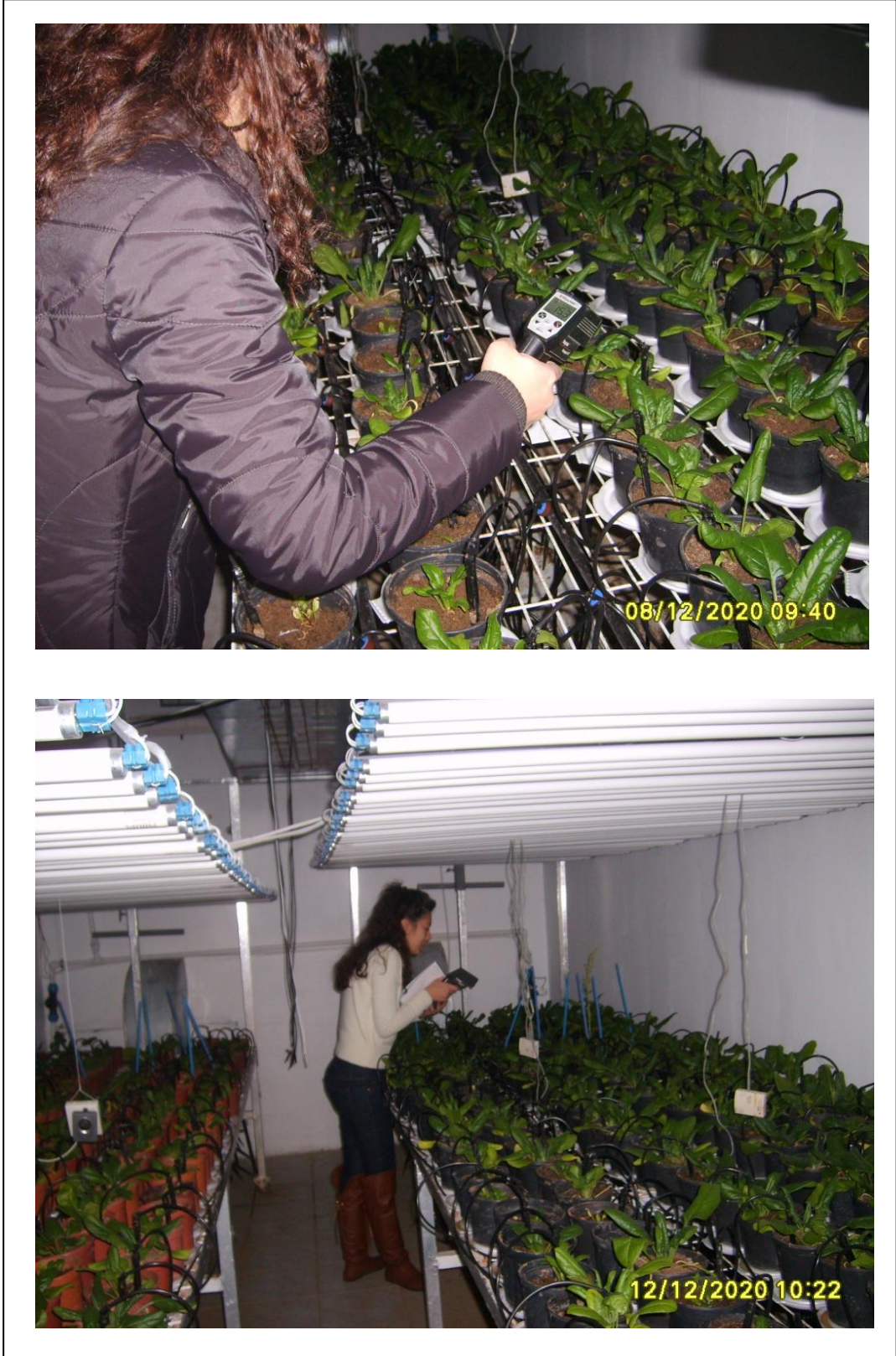
Şekil 3.10. Infrared termometre yardımıyla ıspanak yaprak yüzey sıcaklığının ölçümü
