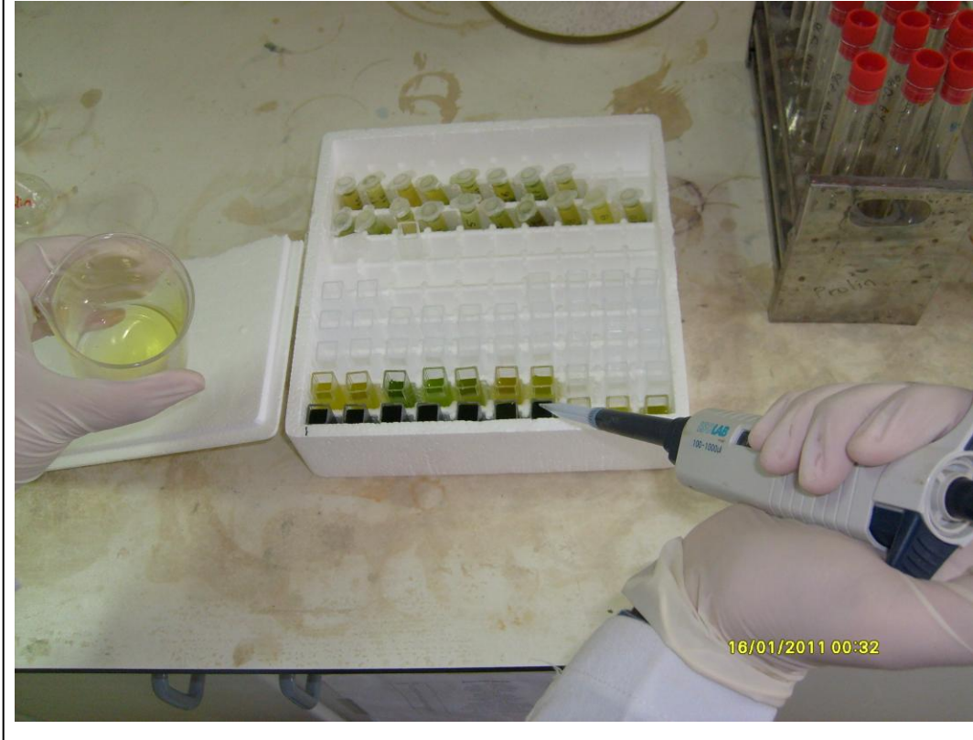
Şekil 3.15. İspanak yapraklarında malondialdehit (MDA) miktarını tespit amacıyla örneklerin spektrofotometre ölçümlerine hazırlanması
