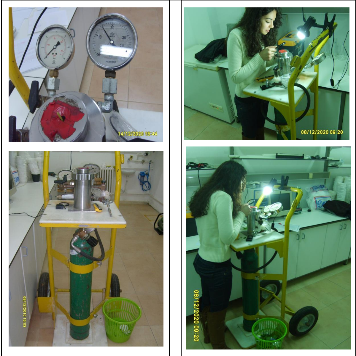
Şekil 3.9. Yaprak su potansiyeli ölçme cihazı olan scholander basınç odası ve yapılan ölçümlerden görünüm
