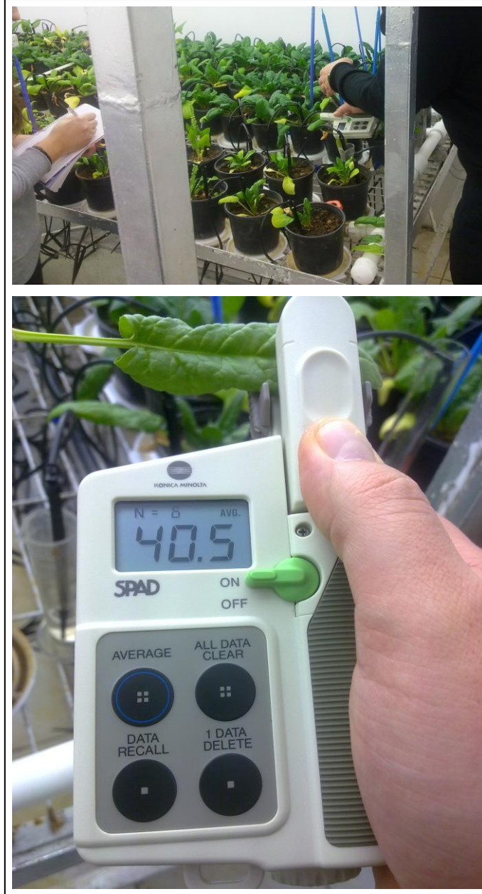
Şekil 3.12. Klorofil ölçüm cihazı ve ıspanakların kuraklık stresi sonrası klorofil ölçümlerine ait görüntüler
