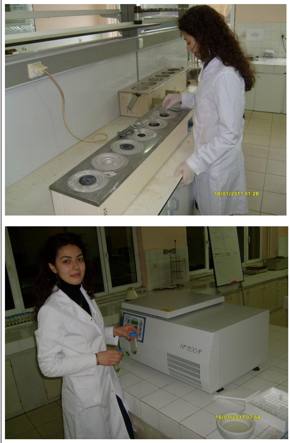
Şekil 3.13. Ispanak yaprak ekstratlarının serbest Prolin tayini amacıyla 100 °C'de su banyosunda bekletilmesi ve daha sonra santrifüze yerleştirilmesi aşamasına ait görüntüler
