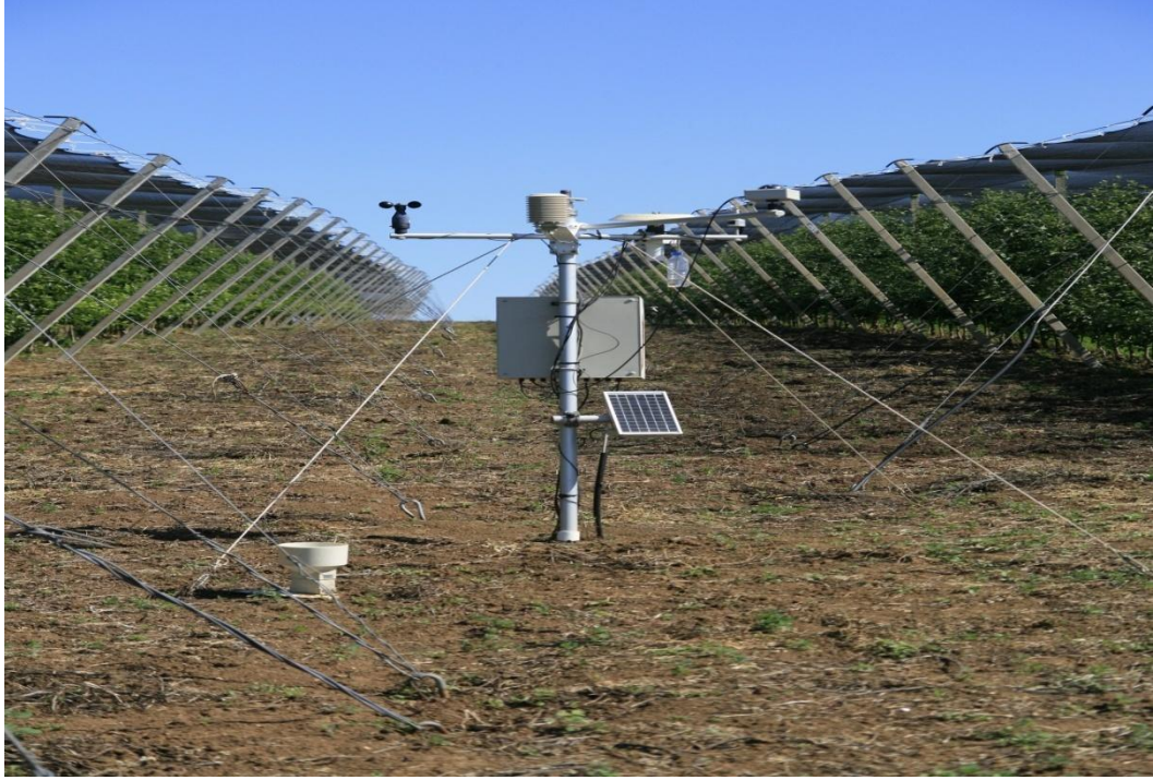
Şekil 3.1. Deneme alanında yer alan meteoroloji istasyonu
