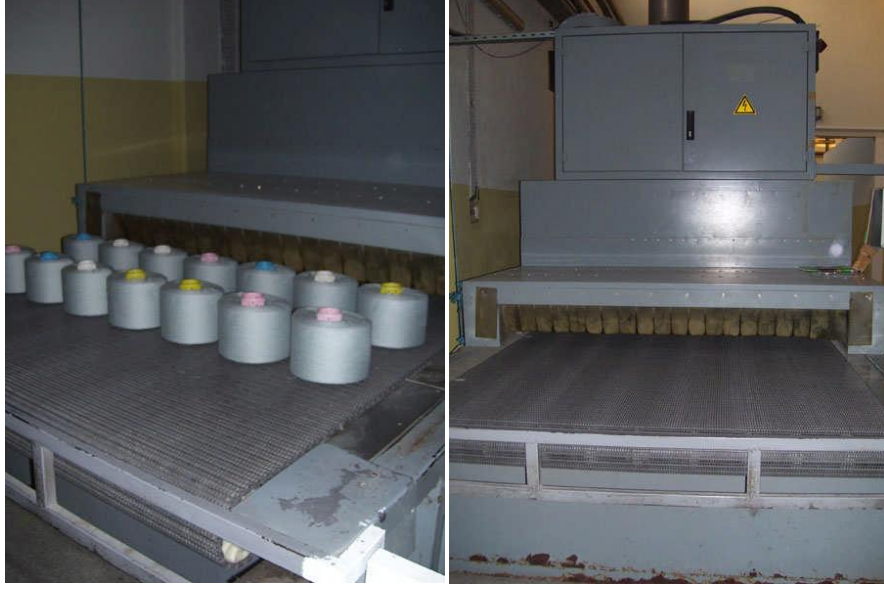
Şekil 2.4 Yüksek frekansla kurutma sistemi (Megep, 2008)
