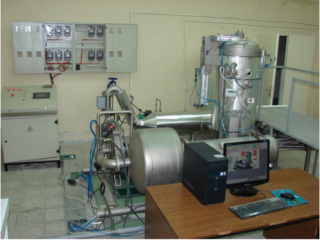
Şekil 5.16 İplik bobini kurutma deney düzeneği
