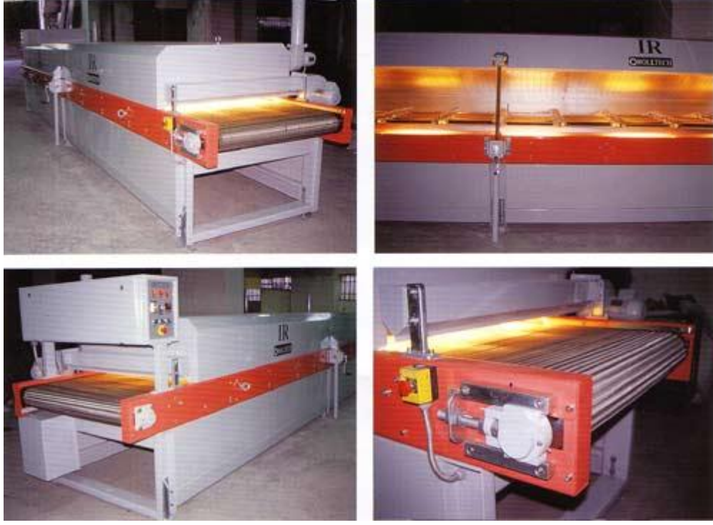
Şekil 2.3 Işınım ile kurutma sistemi (Rolltech, 2011)
