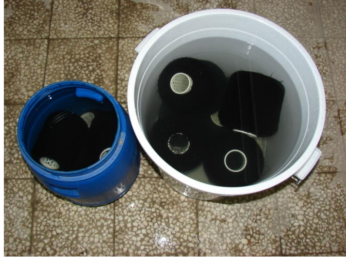
Şekil 5.14 Bobinlerin su banyosunda ıslatılması
