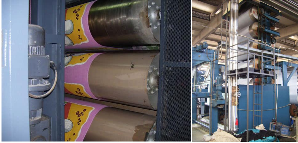
Şekil 2.2 İletimle kurutma (silindirli kurutma) makinesi (Megep, 2008)
