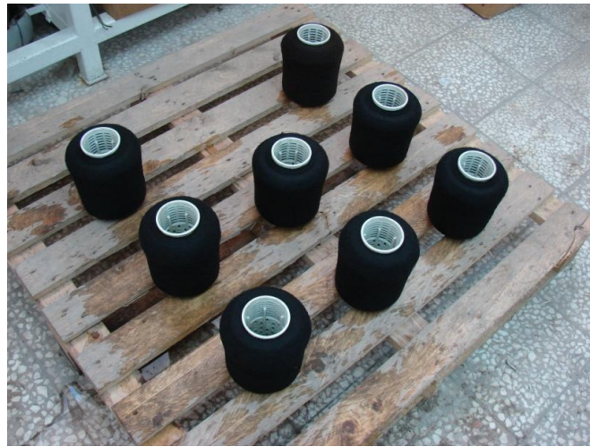
Şekil 5.15 Süzülme bırakılan yün iplik bobinleri
