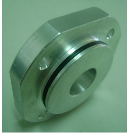
Şekil 3.3 Kapak O ringinin monrajlı hali
