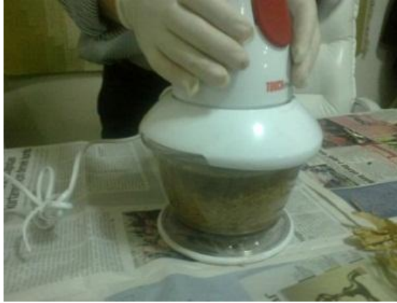
Şekil 3.7. Atıkların kıyıcıda kıyılma işlemi
