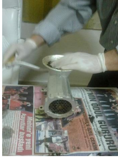
Şekil 3.10. Kıyma Makinasında Pelet Baskı işlemi
