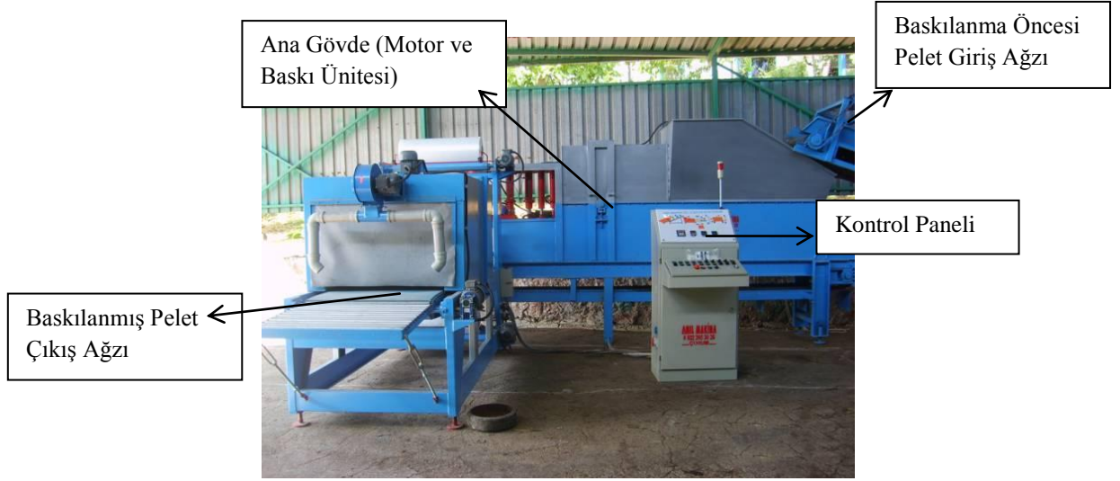
Şekil 4.8. Pelet-Baskı Ünitesi (Kaynak: Alpsan Makine Sanayi ve Ticaret A.Ş./ESKİŞEHİR)
