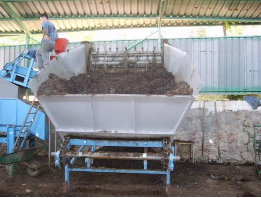
řekil 4.7. Pelet Ykleyici Helezon nitesi (Kaynak: Alpsan Makine Sanayi ve Ticaret A.ř./ESKİřEHİR)
