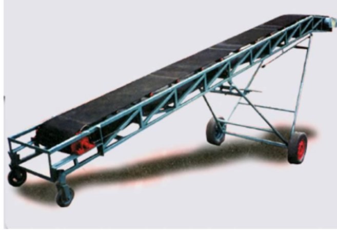
Şekil 4.9. Besleme Ünitesi (Kaynak: Alpsan Makine Sanayi ve Ticaret A.Ş./ESKİŞEHİR)
