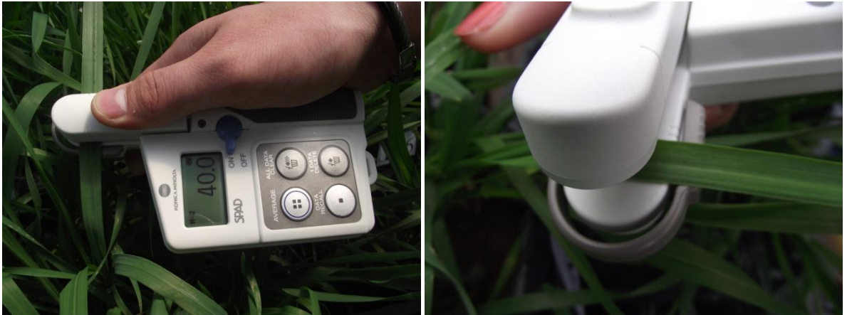
Şekil 3.5. Klorofilmetre ile ölçümün yapılması
