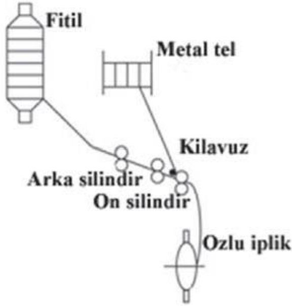
Şekil 2. 27 Modifiye edilmiş ring iplik makinasında, fitil ve metal telin özlü iplik eğirme sistemi mekanizmasındaki işlevini gösteren diyagram
