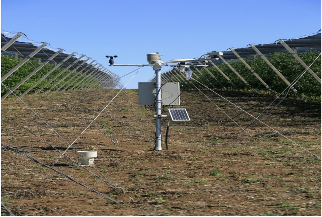
Şekil 3.1. Deneme alanında yer alan meteoroloji istasyonu
