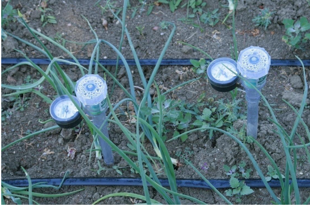
Şekil 3.8. Deneme alanında kullanılan tansiyometreler
