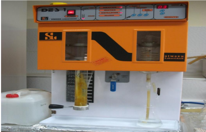
Şekil 3.23. Kjelted distilasyon cihazı
