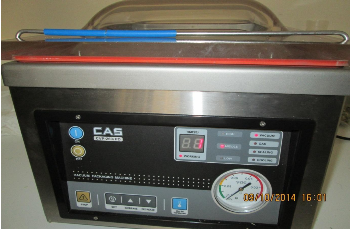
Şekil 3.1. Laboratuvar tipi paket silaj makinası
