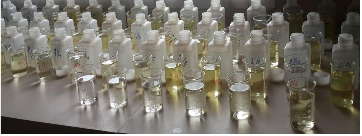
Şekil 3.8. Fosfor tayininde spektrofotometrede okumaya hazırlanmış çözeltiler.
