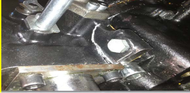
Şekil 4.6 Çek bırak testinde kırılma yaşanan gövde
