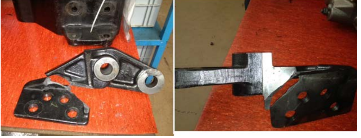
Şekil 4.2 İlk tasarım braketlerde ömür testlerinde yaşanan kırılmalar
