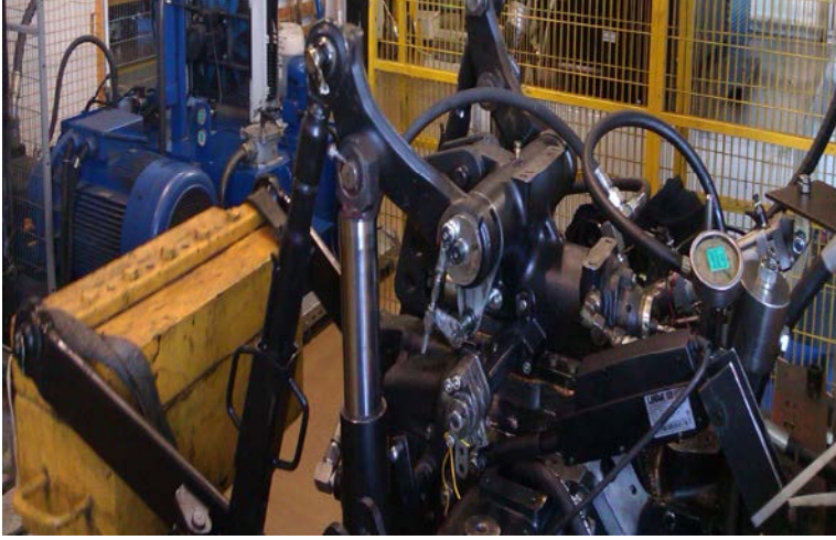
Şekil 3.32 İndir-kaldır ömür testi güç kontrol kol bölümü
