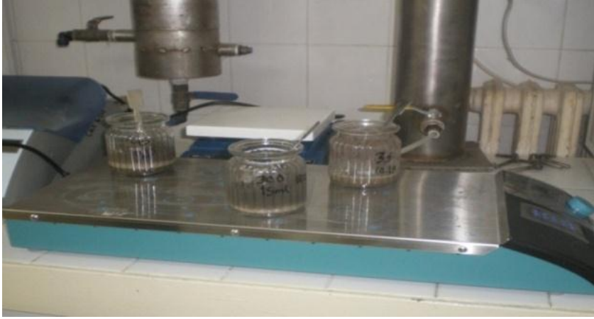
Şekil 3.1. Fenton yöntemi uygulanmış çamurların karışma anı
