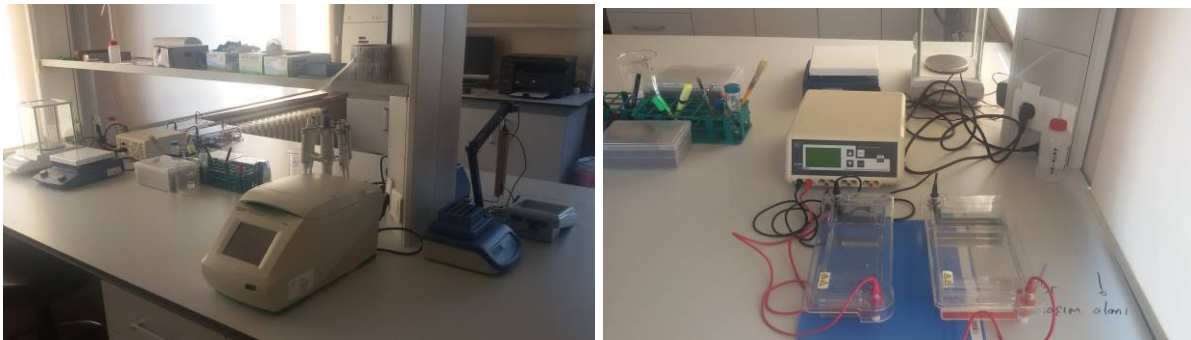
Şekil 3.9. Moleküler çalışmada kullanılan PCR ve elektroforez cihazı
