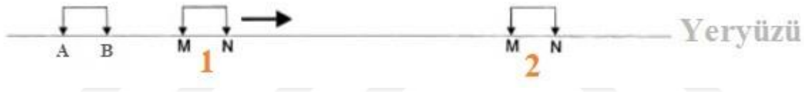
Şekil 2.8. Dipol Dipol dizilim için toprağa çakılan elektrotların yatay doğrultuda hareketi
