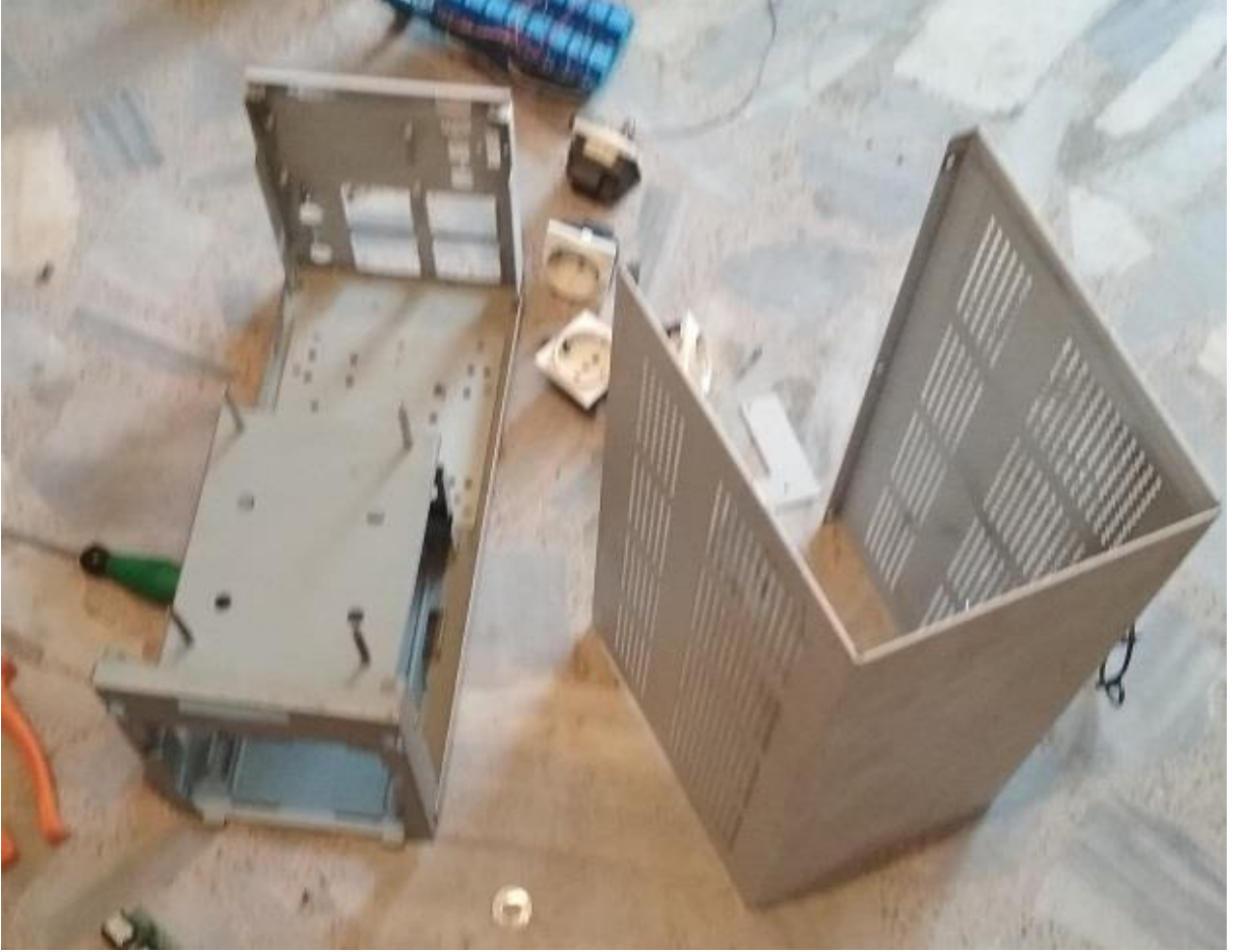
Şekil 3.16. Rezistivite cihazının monte edildiği boş invertör kasası
