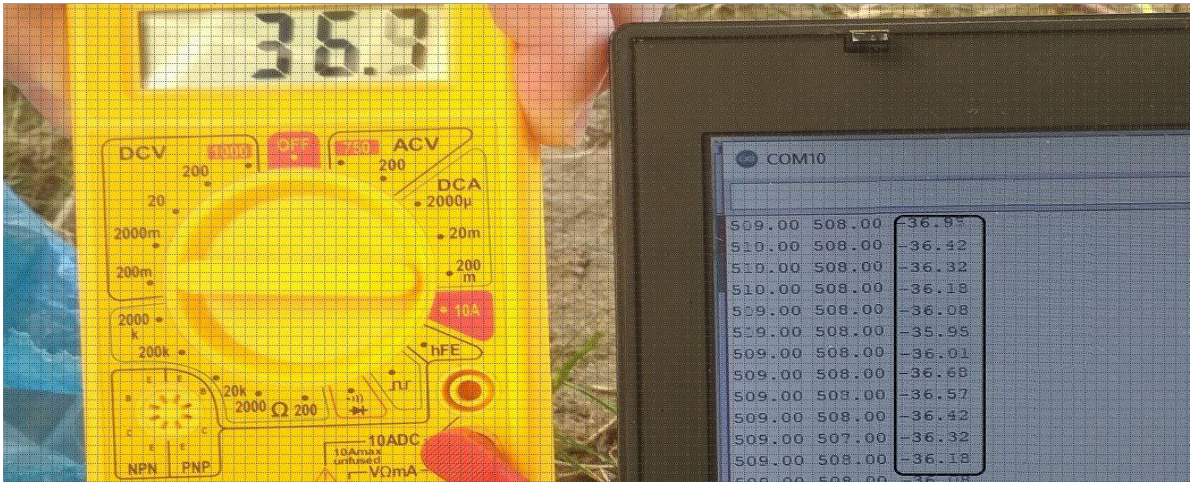
Şekil 5.3. Deney sahasında ampermetre ile cihazın akım kalibrasyonu kontrolü
