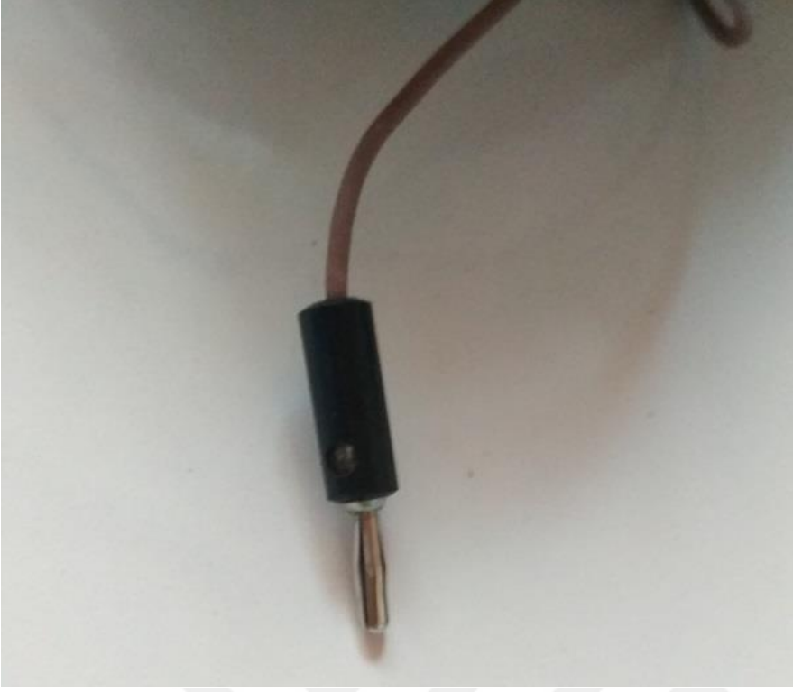
Şekil 3.14. Kabloya bağlanmış siyah standart banana jak
