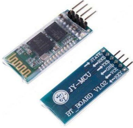
Şekil 3.6. HC06 Bluetooth-Serial haberleşme modülü [40]
