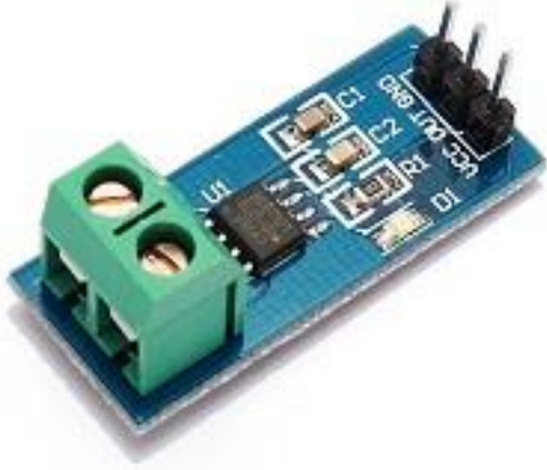
Şekil 3.3. ACS712 akım sensörü [39]
