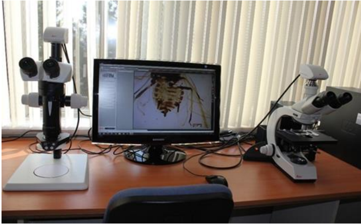
Şekil 3.8. Yaprakbitlerinin tür teşhisinde kullanılan ışık mikroskobu LEICA DM LB2
