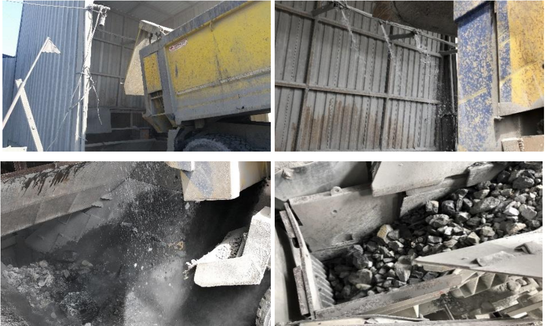
Şekil 3.11. Birincil Kırıcıya Malzeme Yüklenmesi ve Kırma İşlemi
