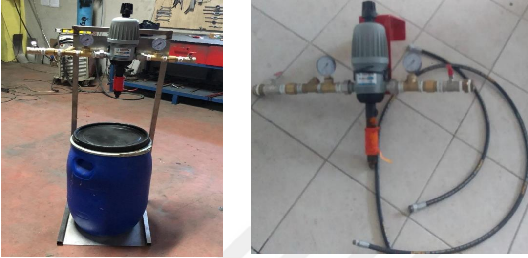
Şekil 3.10. Dozajlama pompası montajı
