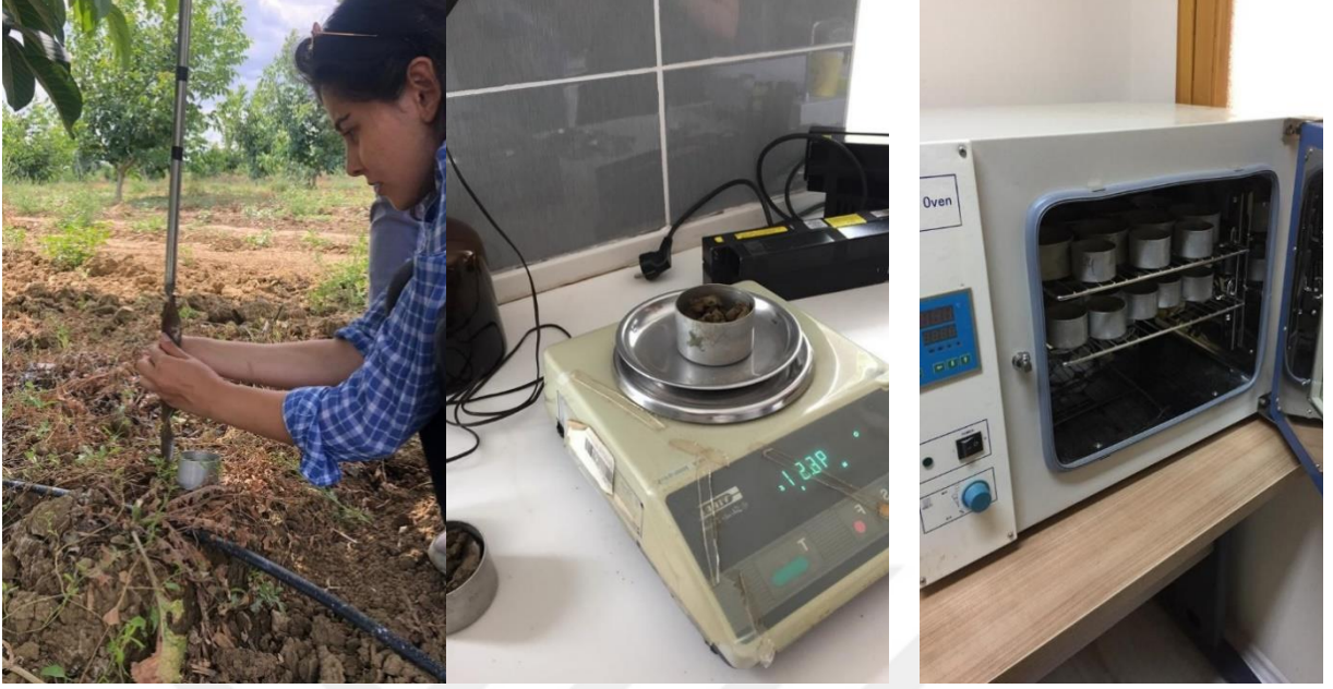
Şekil 3.10. Gravimetrik metodun uygulanması
