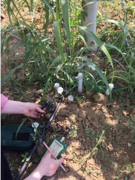
Şekil 3.12. Watermark toprak nem sensörü ile ölçüm alımı
