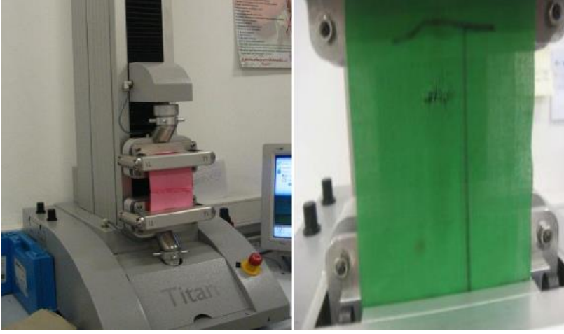
Şekil 3.3. James HEAL/ Titan (Kopma mukavemeti test cihazı)
