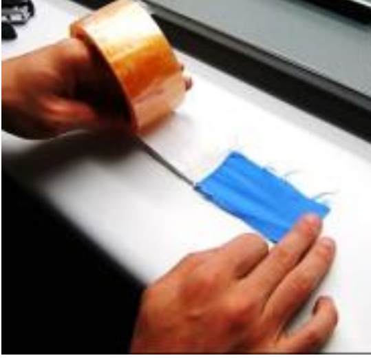
Şekil 3.8. Multifiber kumaş üzerindeki tüyün alınması
