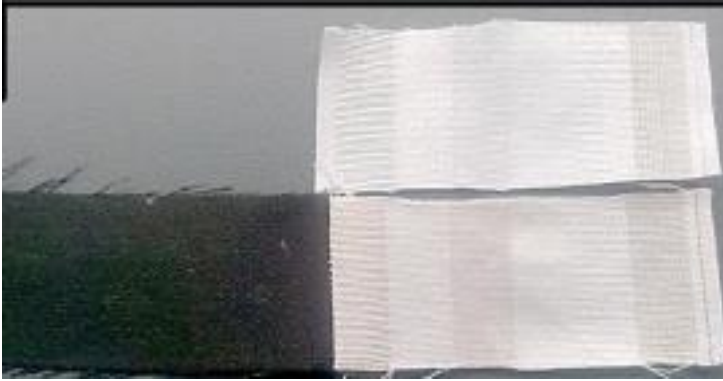
Şekil 3.9. Test sonrası multifiber kumaşın karşılaştırılması
