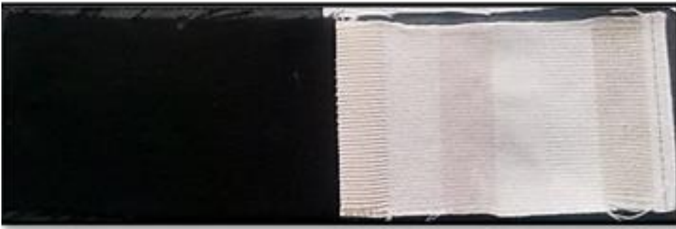
Şekil 3.7. Numune kumaşın multifiber kumaşla dikilmiş hali
