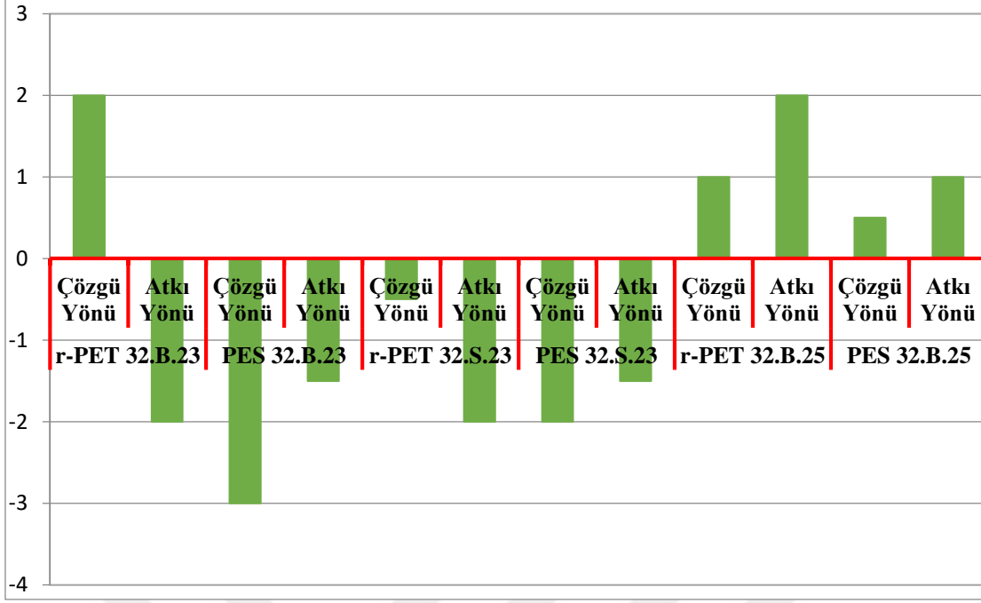
Şekil 4.3. İkinci grup (PES-Pamuk-Viskon-EL Karışımı) numune çalışmalarına ait yıkama çekmezliği test sonuçları
