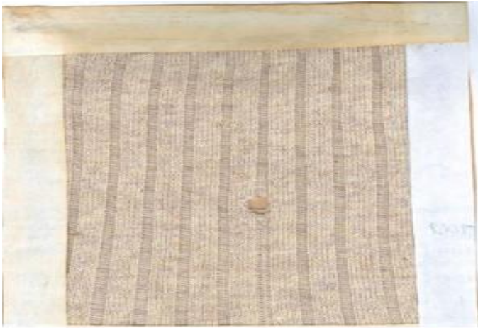
Şekil 4.11. Dilin kapalı kalmasıyla delik oluşması
