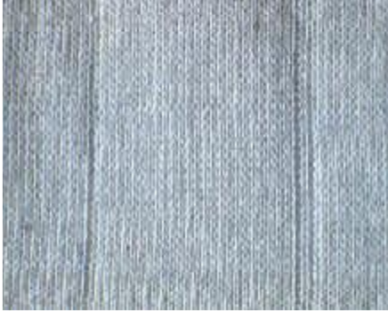
Şekil 4.20. Kilit mekanizmalarının aşınmasından dolayı oluşan hatanın kumaş yüzeyindeki görüntüsü
