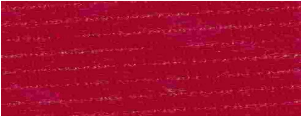
Şekil 4.5. İplik Hammaddesinin Farklılığından Kaynaklanan Enine Çizgi Hatasının Kumaş Yüzeyindeki Görüntüsü
