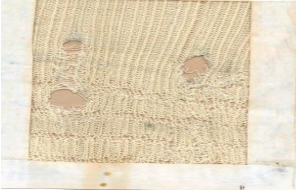
Şekil 4.13. Dilin kırılmasıyla oluşan delik Şekil 4.14. Hataya neden olan iğne
