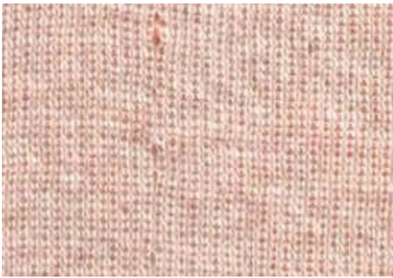
Şekil 4.17. İğne delikleri hatasının kumaş yüzeyindeki görünümü
