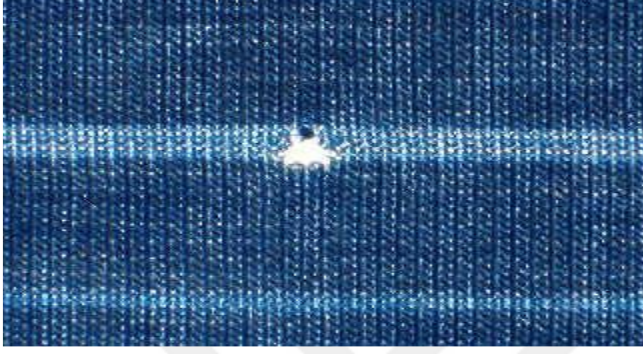
Şekil 4.21. Kumaş yüzeyinde meydana gelen iplik kesilmesinin görünüşü
