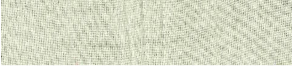
Şekil 4.25. Renkli Uçuntu Hatasının Görünümü
