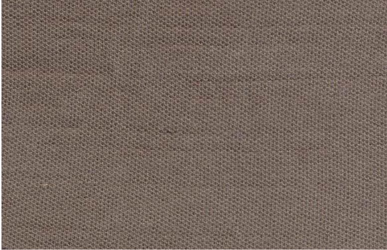
Şekil 4.6. İplik Gerginlik Farkından Kaynaklanan Enine Kesikli Çizgi Hatasının Kumaş Yüzeyindeki Görüntüsü
