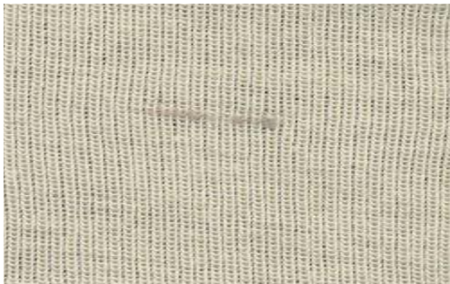
Şekil 4.24. Renksiz Uçuntu Hatasının Görünümü
