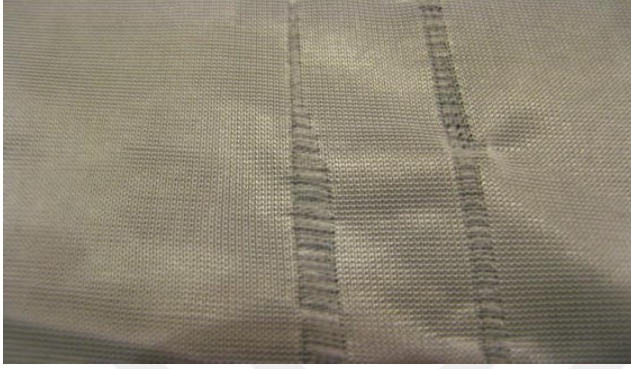
Şekil 4.18. İlmeğin kayması hatasının kumaş yüzeyindeki görünümü
