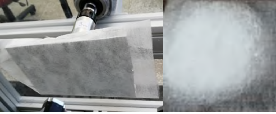
Şekil 2.8. Nanoweb yüzey üretiminde kullanılan kollektör ve nanoweb
