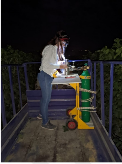
Şekil 3.3. Şafak öncesi Yaprak Su Potansiyeli ölçümü (Aktaş Fatma Betül 2020 Orijinal Fotoğraf)
