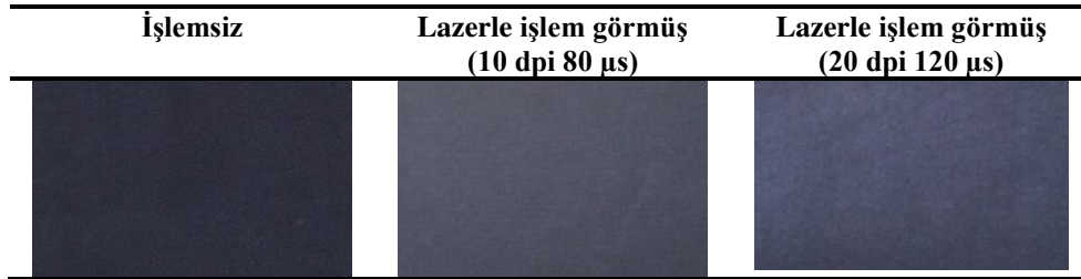
Çizelge 4.48. Ön yüzü indigo boyalı pamuk/akrilik iplik ile arka yüzü siyah boyalı poliester/elastan iplikten oluşan tayt kumaşlarının 10 dpi 80 µs ve 20 dpi 120 µs lazer işlemine tabi tutulmuş hâllerinin fotoğrafları
