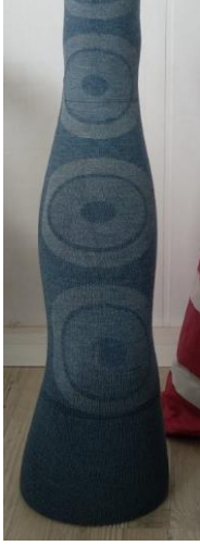
Şekil 4.9. Reaktif boya ile boyanıp ardından lazer ile desenlendirilmiş ön yüzü %100 pamuk iplik ve arka yüzü siyah boyalı poliester/elastan iplikten üretilmiş tayt numunesi
