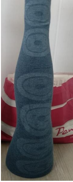
Şekil 4.8. Lazer ile desenlendirilip ardından reaktif boya ile boyanmış önyüzü %100 pamuk iplik ve arka yüzü siyah boyalı polyester / elastin iplikten üretilmiş tayt numuneleri
