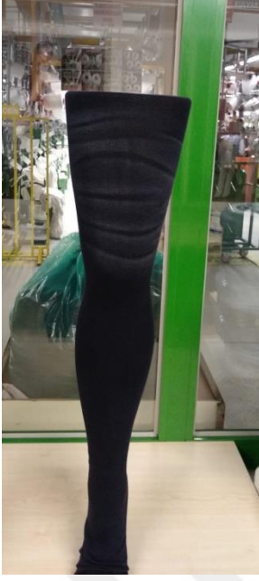
Şekil 4.20. Ön yüzü indigo boyalı pamuk/poliakrilonitril ipliği ve arka yüzü siyah boyalı poliester/elastan iplikten oluşan taytlarda lazer ile desenlendirme
