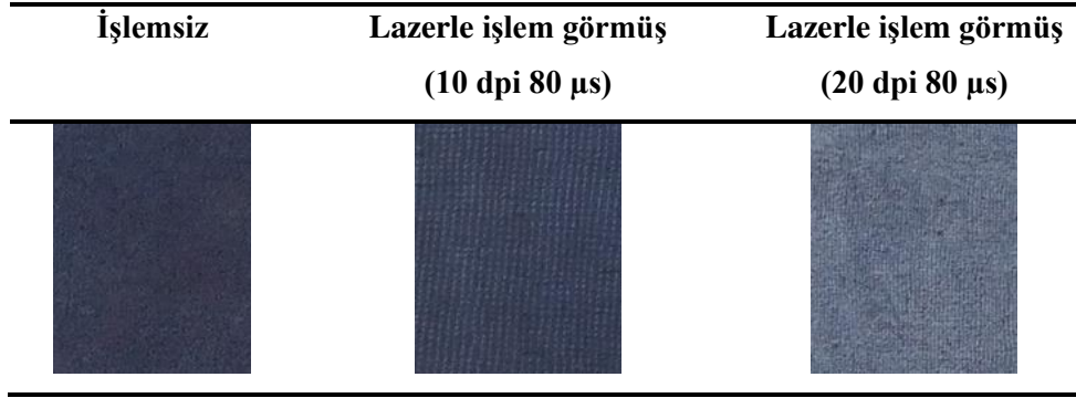
Çizelge 4.31. Çeşitli koşullarda lazerle işlem görmüş ve işlemsiz ön yüzü indigo boyalı pamuk iplik ve arka yüzü siyah boyalı poliestere/elastandan yapılmış tayt kumaşı numuneleri
