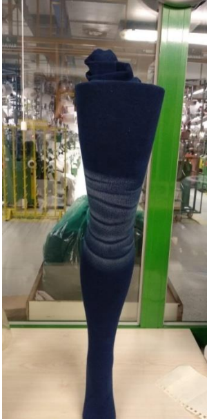
Şekil 4.11. Lazer ile desenlendirilmiş ön yüzü indigo boyalı pamuk ipliği ve arka yüzü siyah boyalı poliester/elastan iplikten oluşan tayt numunesi
