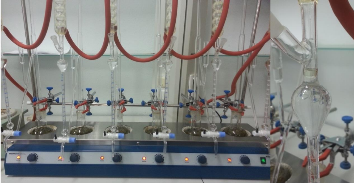
Şekil 3.9. Uçucu yağ çıkarma ünitesi ve elde edilen uçucu yağ
