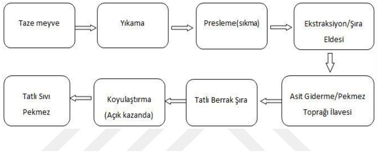
Şekil 2.2. Geleneksel yöntemle tatlı sıvı pekmez üretim aşamaları (Kaya, Yıldız, Hayoğlu ve Kola, 2005)
