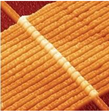
Şekil 2.4. HP Laboratuvarı tarafından verilen TiO_2 memristör fotoğrafı [13]
