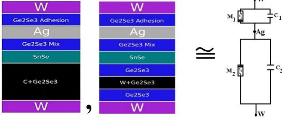
Şekil 7.8. Karbon ve Tungsten tabanlı memristör topolojilerinin düşünülen eşdeğer devresi
