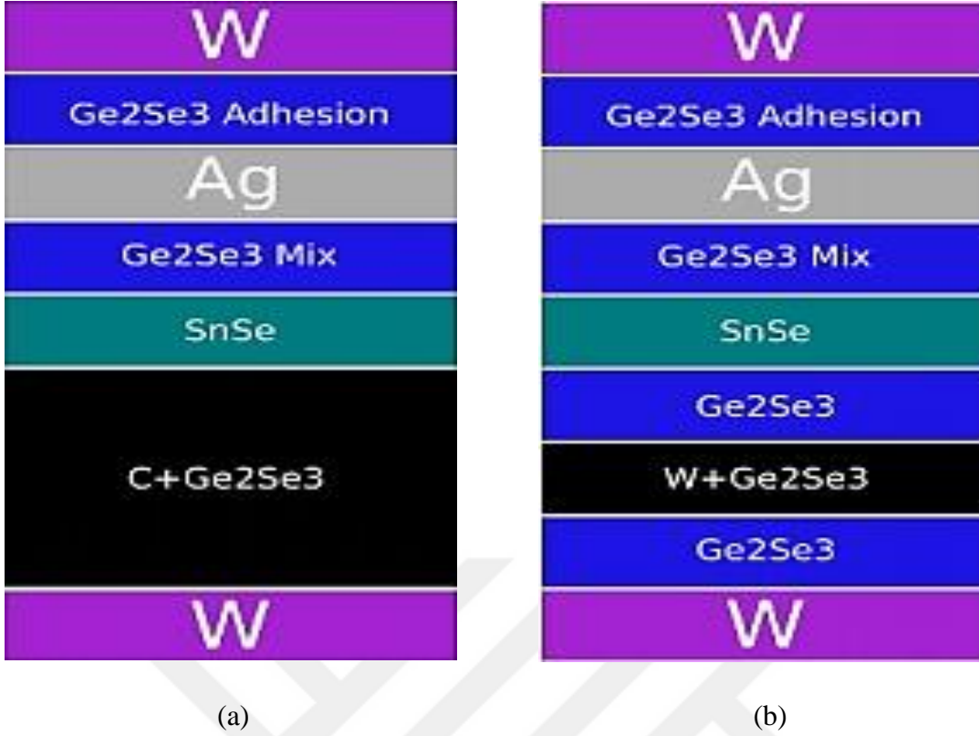
Şekil 4.3. a) Karbon(C) ve b) Tungsten(W) tabanlı Knowm Memristörü topolojileri [33]
