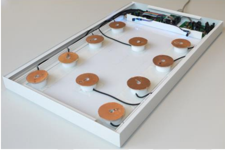
Şekil 2.3. Merkeзде 2 alıcı kenarlarda 8 verici bulunan masanın iç yapısı
