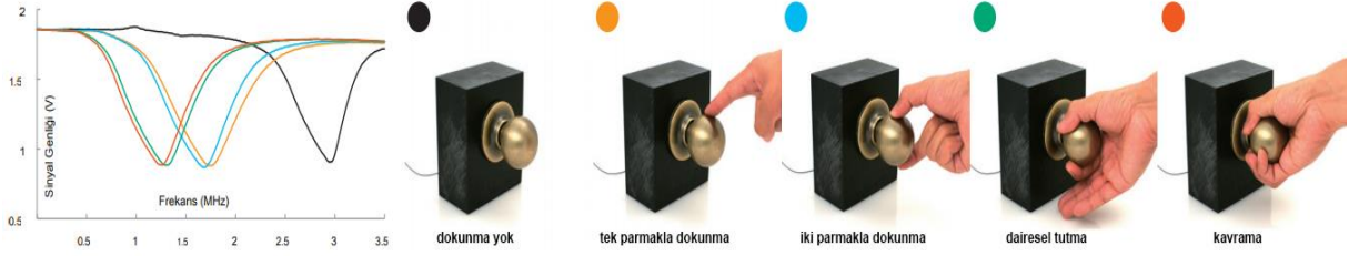
Şekil 2.5. Nesnelerin dokunmasını ve kavramasını hassas hale getirmek için kapasitif profiller (kapı tokmağı örneği)
