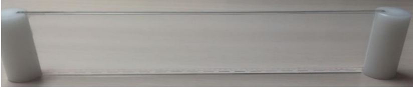
Şekil 4.67. Tasarlanan kenar dalgalanma (marullanma) cetveli
