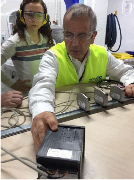
Şekil 3.5. Kalibresi yapılan sensörlerin montaj rayına geçirilerek hazırlanması ve kontrolü
