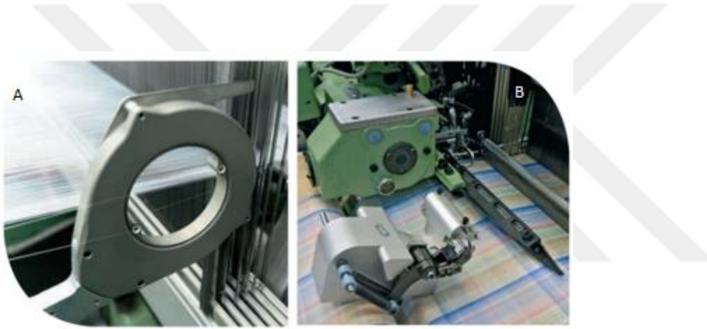
Şekil 2.9. Kenar oluşturma cihazları (A: Leno kenar B: Tuck-in kenar) (Dornier, 2019)
