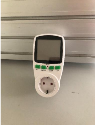
Şekil 3.8. Enerji ölçüm cihazı
