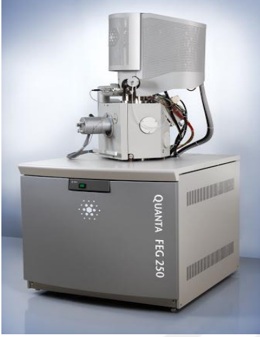
Şekil 3.5. SEM Cihazı ( Scanning Electron Microscope . Erişim tarihi: 20.03.2020. Erişim adresi: https://www.fei.com/products/sem/Quanta-SEM-for-Materials-Science )
