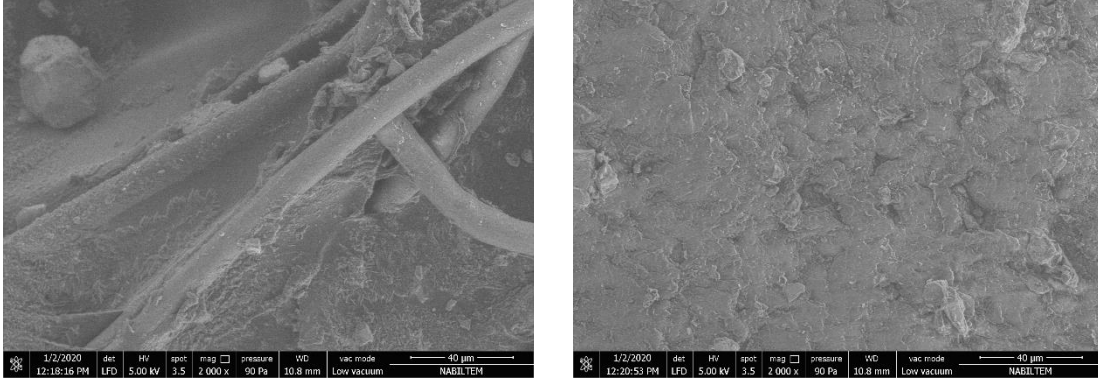
Şekil 4.47. Bantlı Tip Tünel Kurutucu 70 °C - 60 Dakika Su Banyosu (Dış Kısım – İç Kısım)
