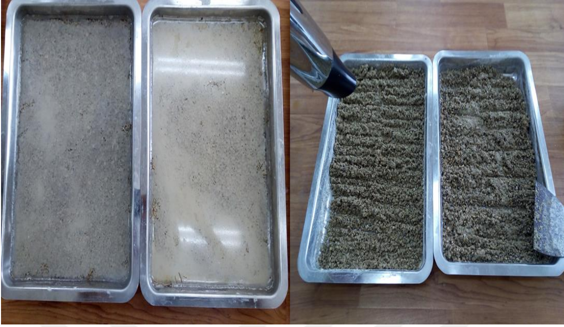
Şekil 6.8. Numunelerin 24 saat su içerisinde bekletilmesi ve sıcak hava kaynağı ile yüzey kuru suya doymun hale getirilmesi
