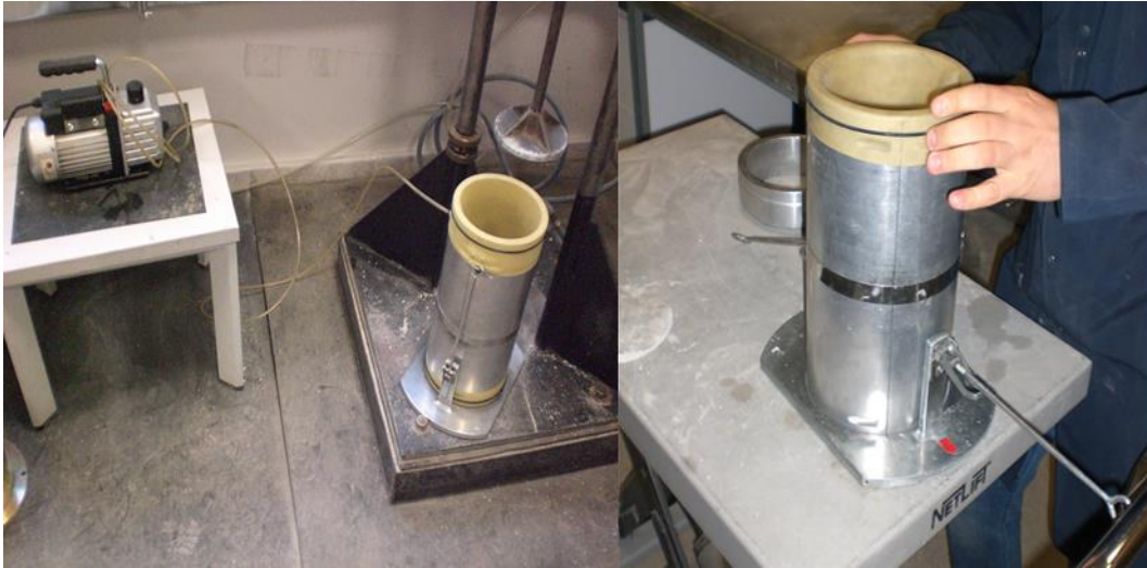
Şekil 6.24. Kalıp içerisine membranın sabitlenmesi ve vakum uygulanması
