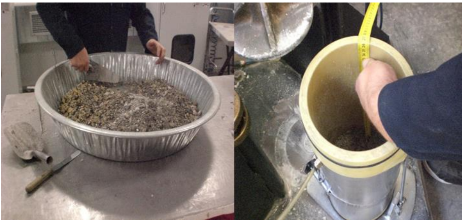
Şekil 6.26. Numune hazırlanması ve yükseklik kontrolü
