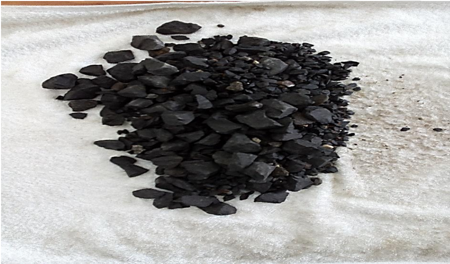
Şekil 6.7. Yüzey kuru suya doymun agrega elde etme
