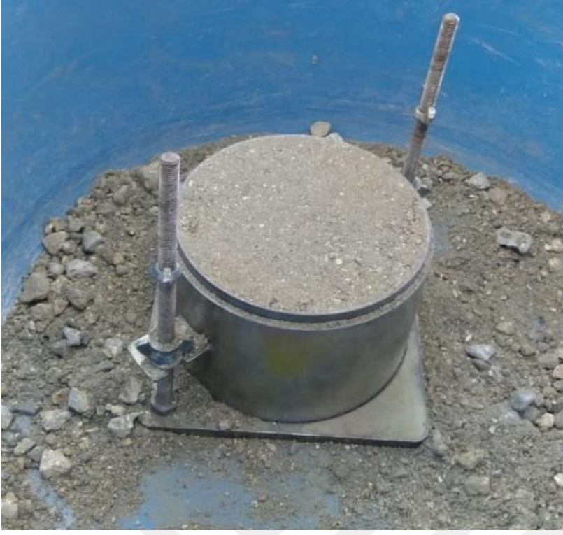
Şekil 6.17.Sıkıştırma işlemi sonrası yüzeyi düzeltilmiş numune
