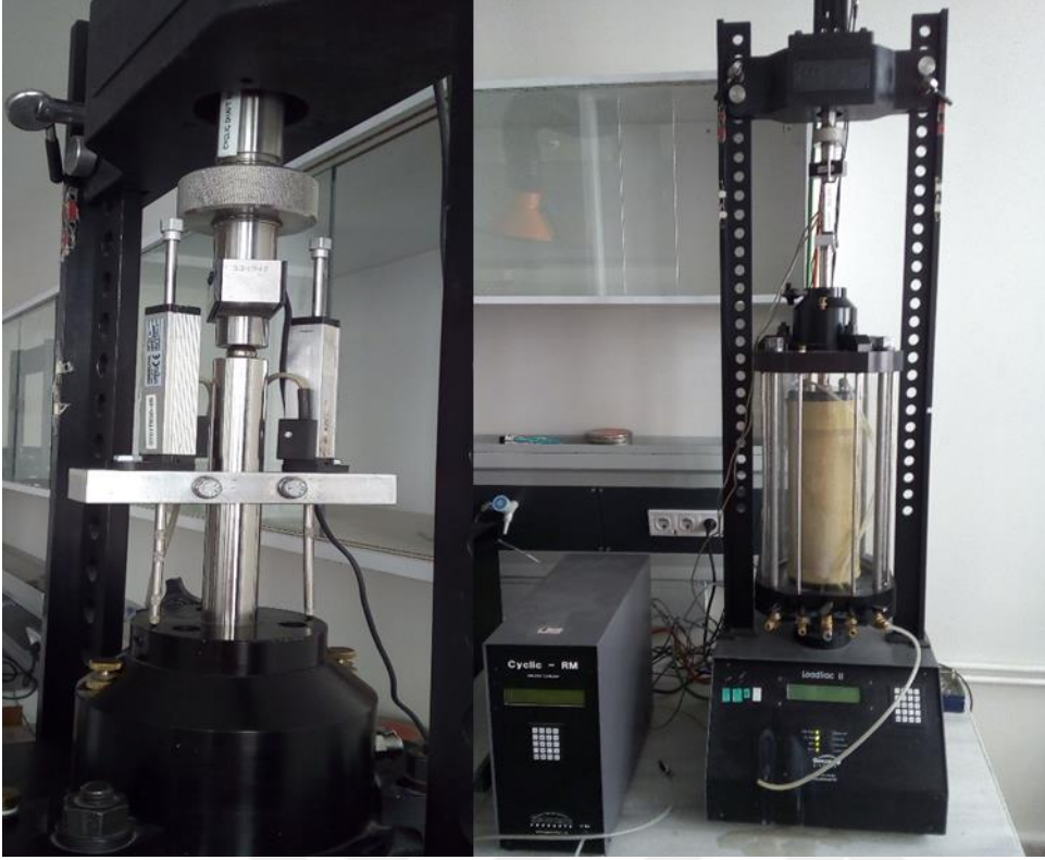
Şekil 6.29. Deformasyon ölçer (LVDT) ve yerleşimi
