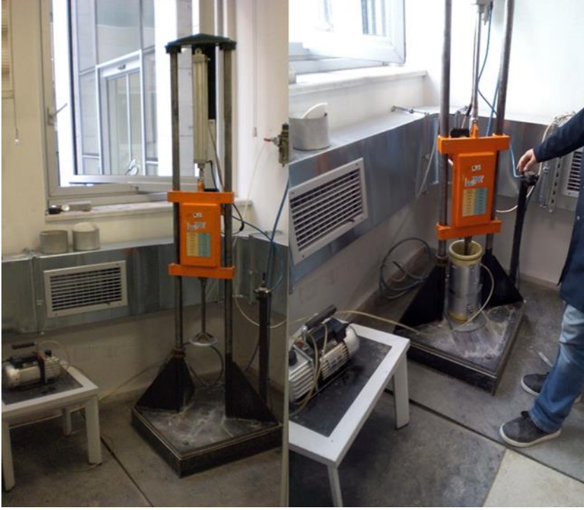
Şekil 6.25. Titreşimli tokmak ve numune sıkıştırılması
