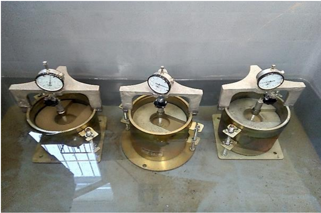
Şekil 6.18. Numunelerin suda bekletilmesi
