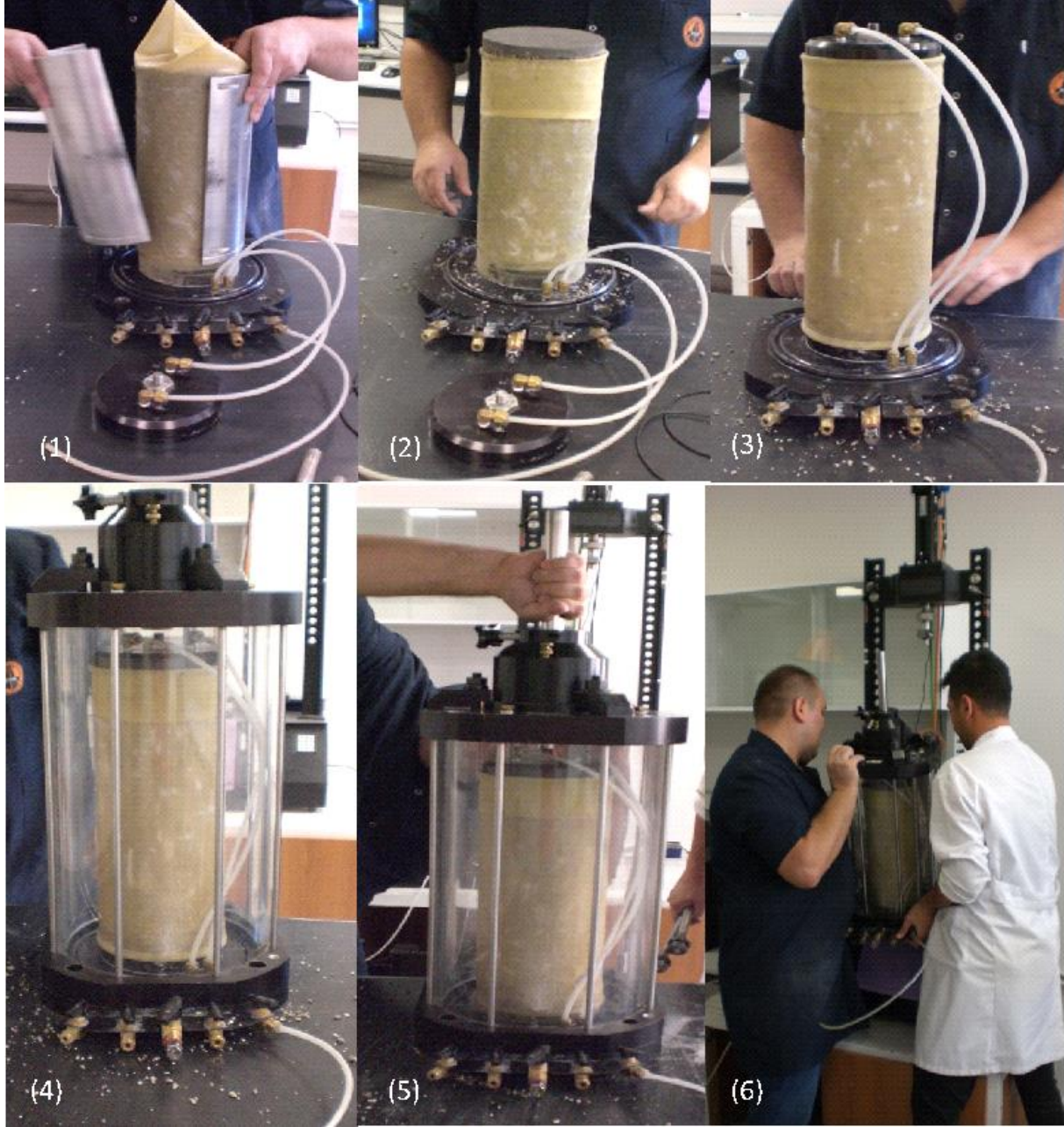
Şekil 6.27. Numunenin kalıptan çıkarılarak deney aletine yerleştirilmesi işlemleri
