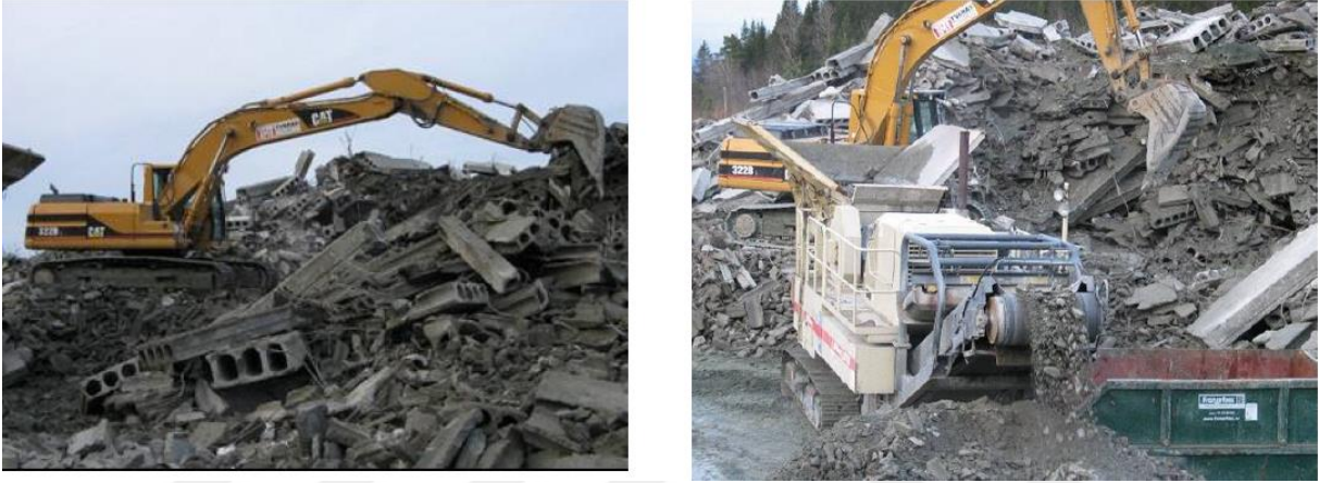
Şekil 5.5. Beton agregasının üretimi (Aurstad vd., 2006)
