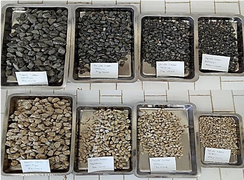
Şekil 6.11. Farklı agrega boyutlarına göre numuneler
