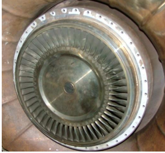
Şekil-4.3.23 Muhafazalı tip kanatçıklara sahip aksel akışlı gaz üretici türbinden bağımsız olan güç türbini
