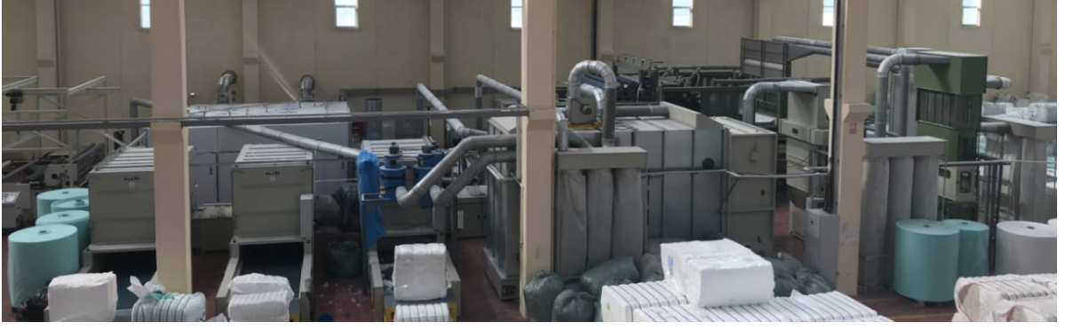
Şekil 3.5. Hava geçişli bağlama yöntemi ile üretilen dokusuz yüzey üretim hattı
