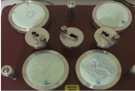
Şekil 4.16. Cihaz üzerinde boncuklanma testi görseli
