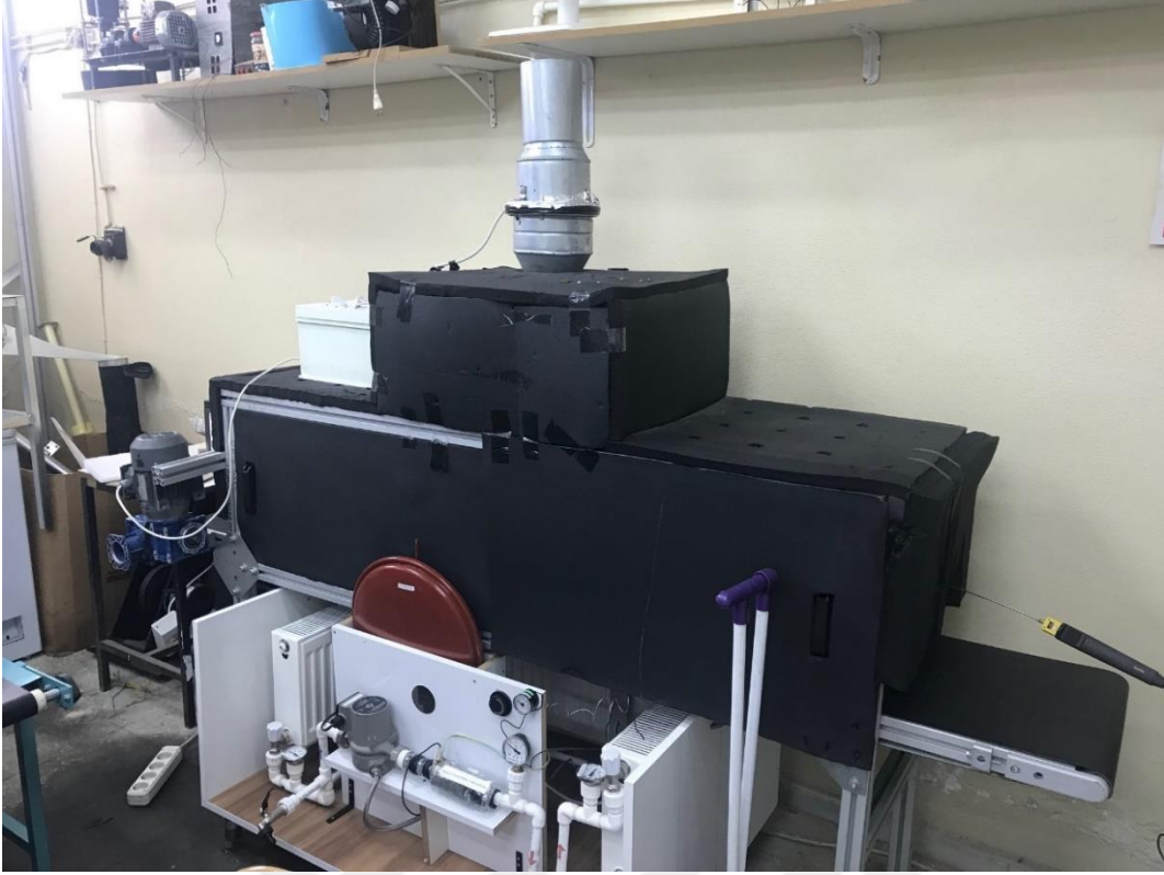
Şekil 3.11. Konveyör bantlı kurutucu deney sistemi
