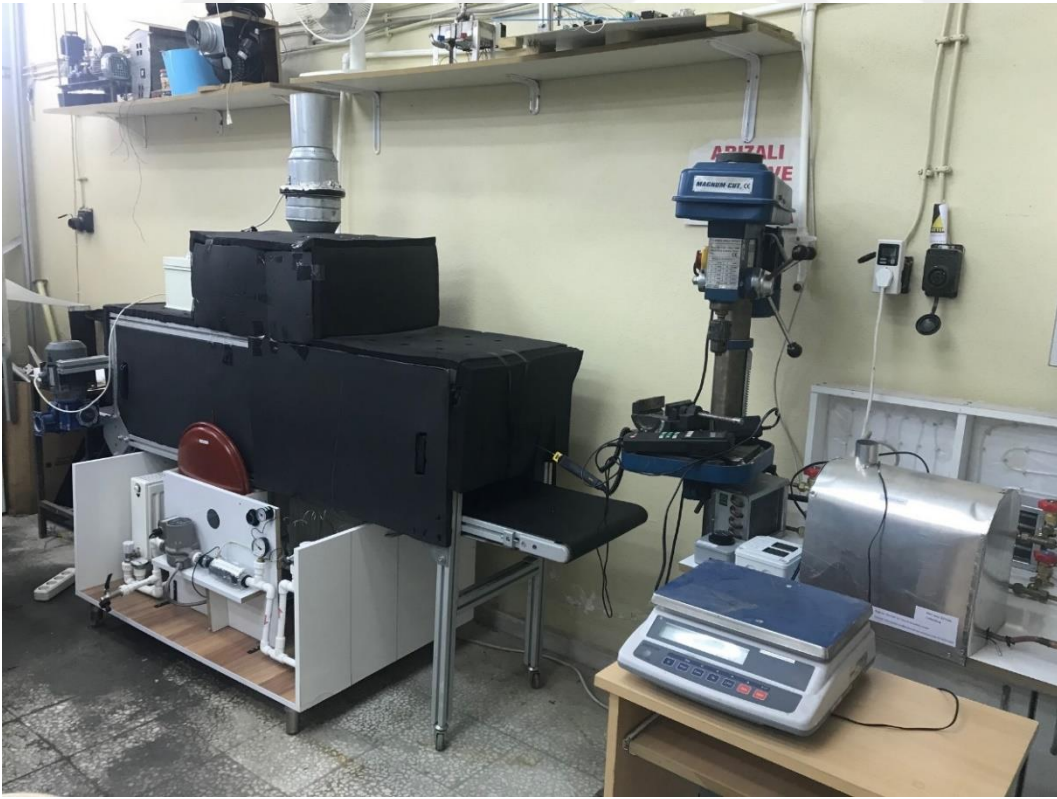
Şekil 3.12. Konveyör bantlı kurutucu deney sistemi
