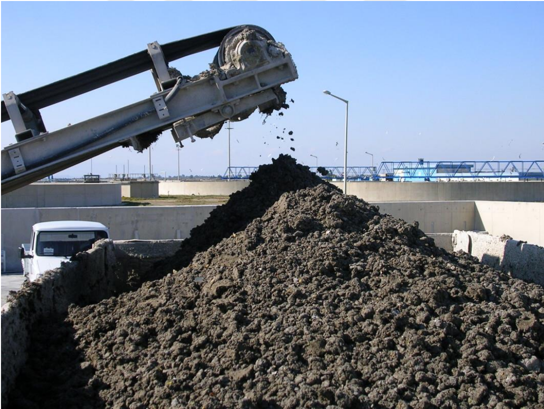
Şekil 2.2. Çiğli Çamur Çürütme ve Kurutma Tesisi' nde üretilen çamur örneği Anonim, (2016a)
