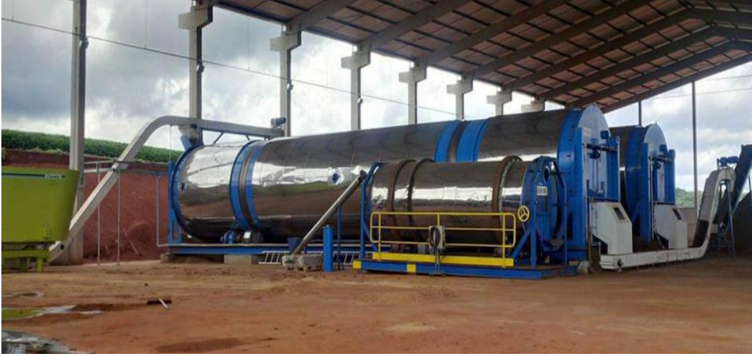
Şekil 2.10. Döner tambur tipi kompost sistemi Anonim, (2019)
