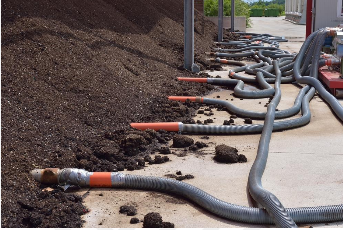
Şekil 2.13. Statik havalandırılmalı sistemi Anonim (2019b)
