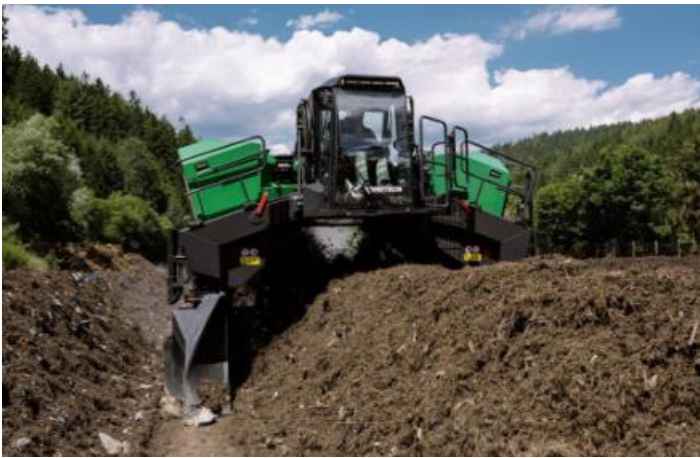
Şekil 2.12. Karıştırırmalı yığın kompost örneği Anonim, (2019a)
