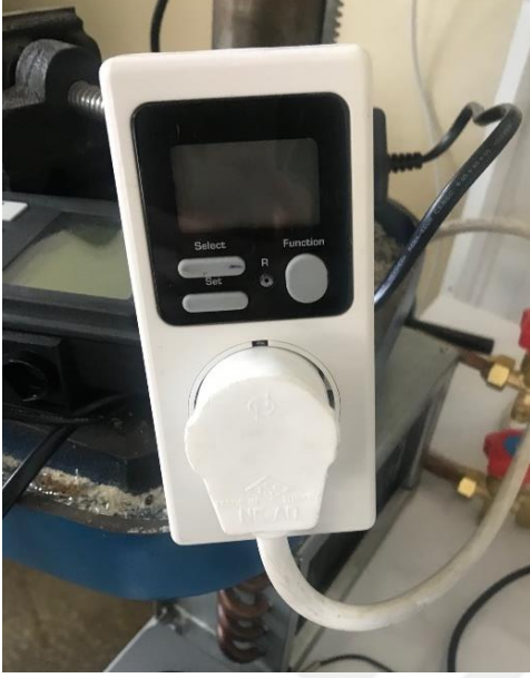
Şekil 3.13. Elektrikli enerji ölçüm sayacı
