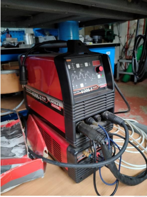
Şekil 3.1. Lincoln Invertec® V205-T AC/DC' TIG kaynak makinesi
