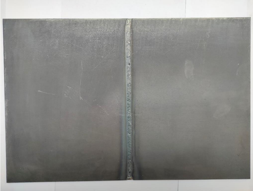
Şekil 3.4. Kaynak ısı tesiri altında numune (300 x 200 x 3 mm)
