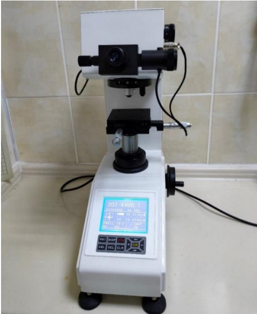
Şekil 3.12. MICROBUL 1000-DN Micro Vickers sertlik ölçme cihazı
