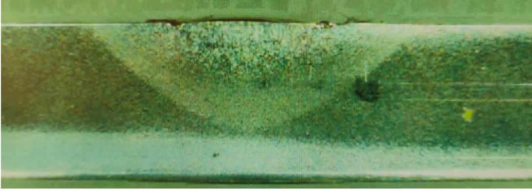
Şekil 4.24. Deneysel 125 A 300 mm/dk için termal analiz nüfuziyet derinliği
