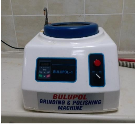
Şekil 3.9. Bulupol zımpara ve parlatma makinesi
