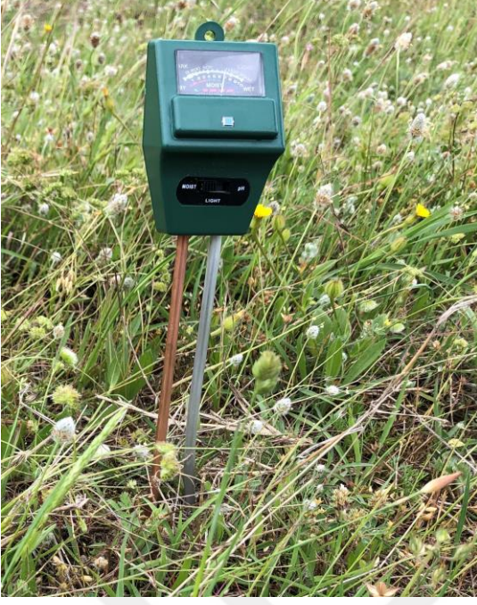
Şekil 3.9. Dijital toprak nemi ölçüm aleti ve toprak neminin ölçümü
