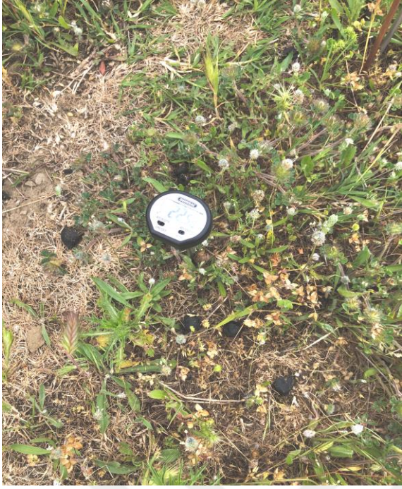
Şekil 3.10. Dijital toprak sıcaklık ölçüm aleti ve toprak sıcaklığı ölçümü
