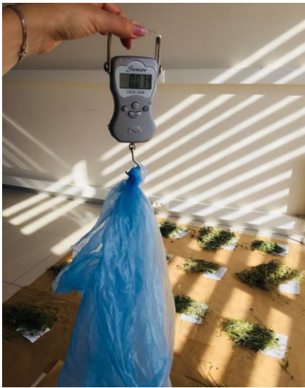
Şekil 3.11. Terazi ile yeşil ot verimlerinin tespiti
