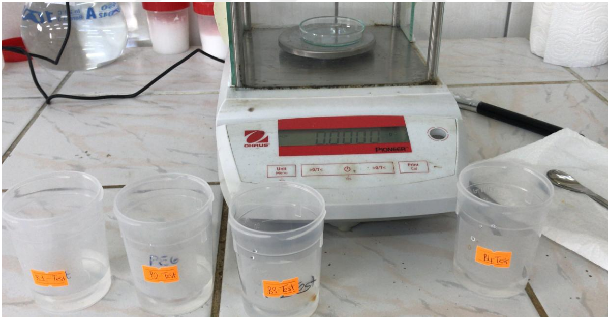
Şekil 3.21. Hidrojellere dinamik şişme testlerinin uygulaması
