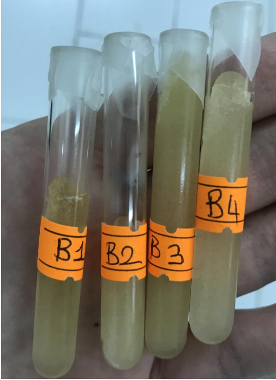
Şekil 3.20. Cam tüpler içerisindeki hidrojeller B1) CS-2 hidrojeli B2) CS-ko-GEL hidrojeli B3) CS-ko-HA (GA ile) hidrojeli B4) CS/HA/GEL hidrojeli
