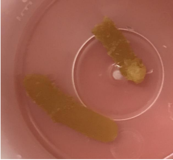
Şekil 3.16. Kuruma sırasında CS-ko-GEL hidrojeli
