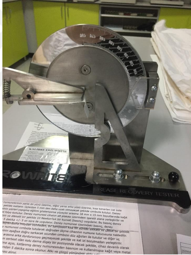
Şekil 3.1. Numunelerin buruşmazlık açısı ölçümü
