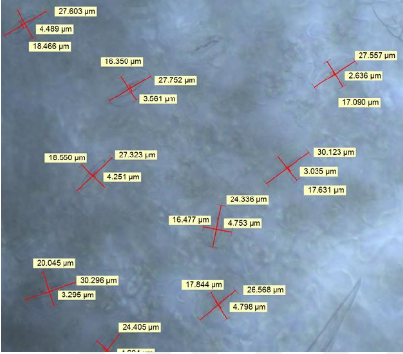
Şekil 3.3. Stoma en, boy ve açıklık ölçümleri
