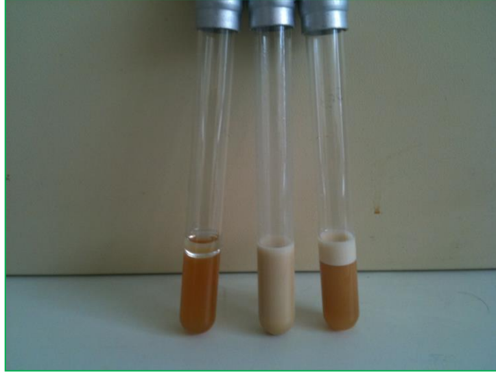
Şekil 4.2.9.1. İzolatlara xylene ilavesi, ilave sonrası tüplerin vortekslenmesi ve spektrofotometrede okumanın yapıldığı aşama
